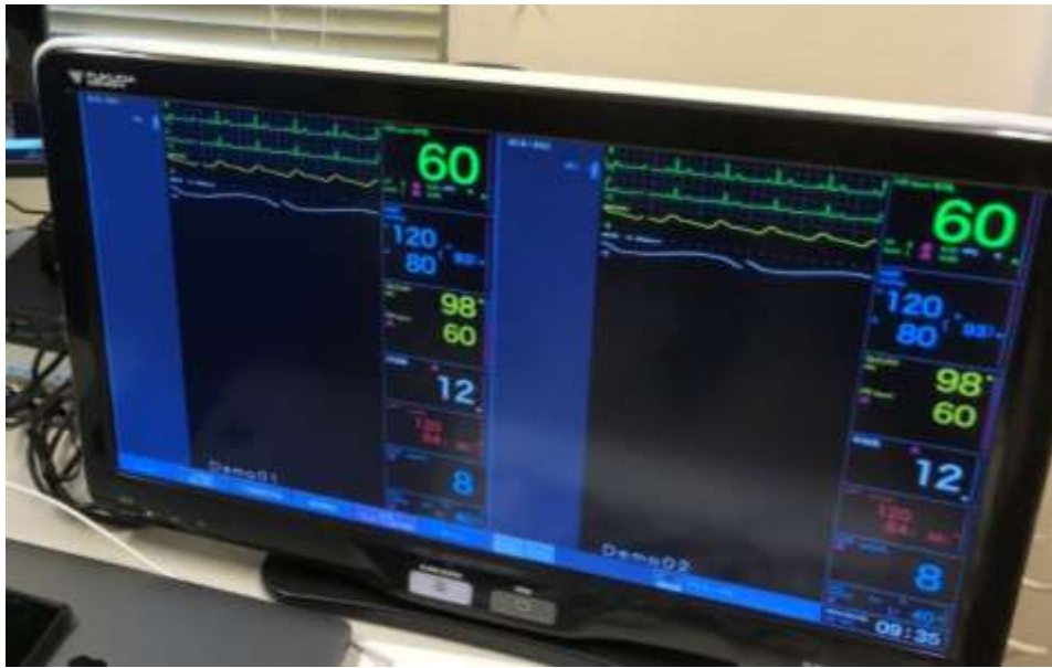
図 4.3.1-4 徳島県立中央病院と徳島大学病院の両院に設置したベッドサイドモニタを徳島県立中央病院のセントラルモニタに表示した結果
