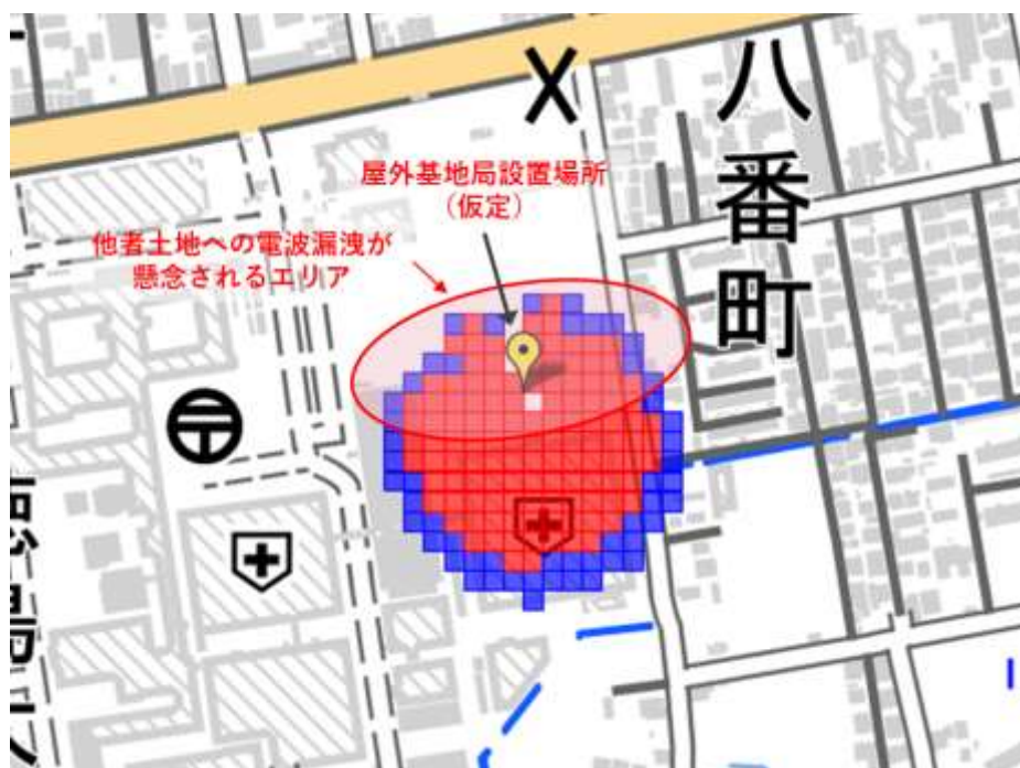
図 3.3.2-1 屋外に無線機を設置する方法 (出典：地理院地図 ※地理院タイルを加工して作成)
