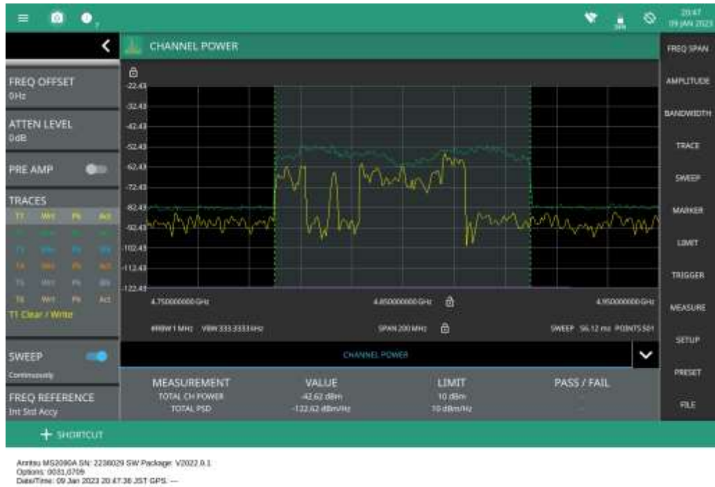
図 3.3.3-16 リソースブロックの最大限利用の確認 (Max Holdで全帯域に送信していることを確認)
