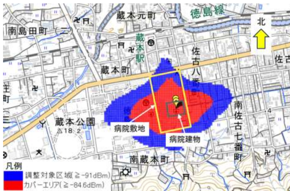
図 3.3.2-51 評価構成 2 光 DAS (+18dBm) 2 台構成 (開放地 屋内設置 損失 6dB) (出典：地理院地図 ※地理院タイルを加工して作成)
