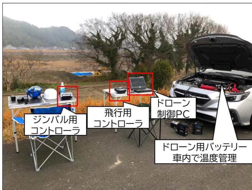
図 3-24 移動局設置状況(上空用)
