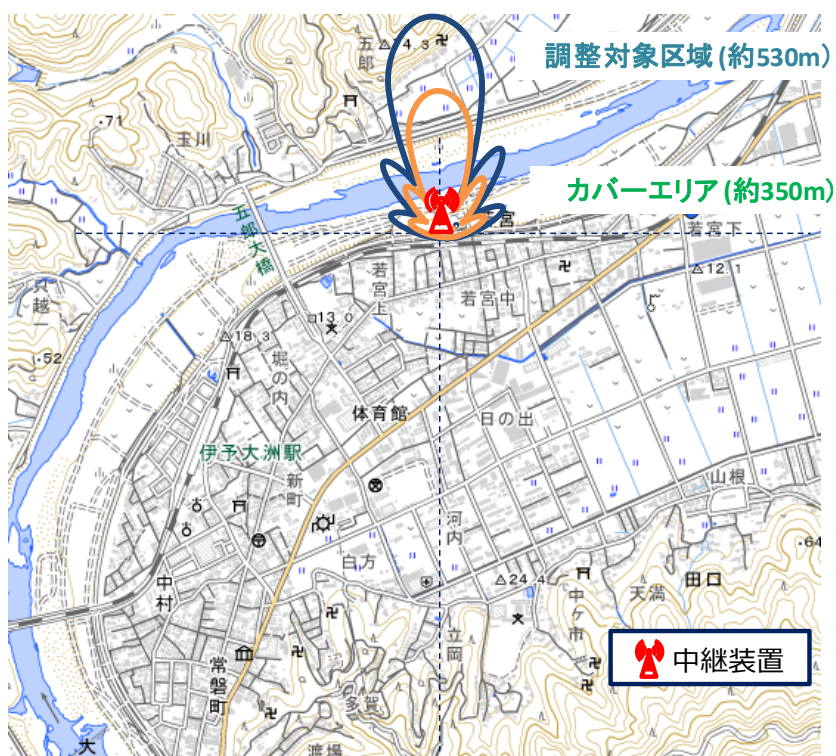
図 2-11 ローカル 5G 中継装置のカバレッジエリア及び調整区域
