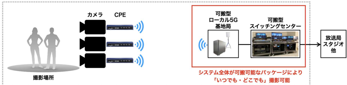
図 4-13 可搬型基地局及び可搬型スイッチングセンターによる構成
