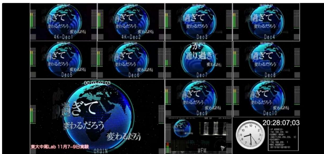
図 4-30 最大 10 チャンネルの伝送状況をモニタするマルチビュー画面の 1 例
