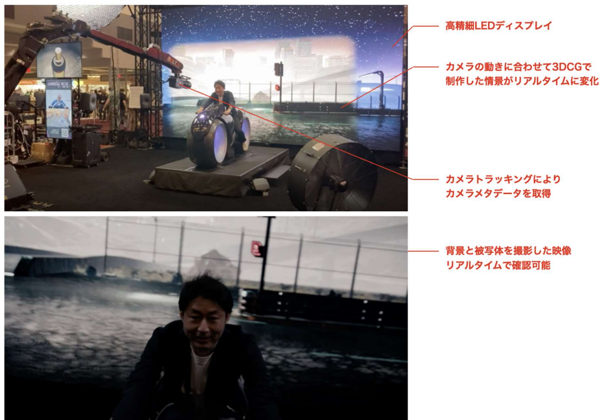
図 4-15 インカメラ VFX の概要
