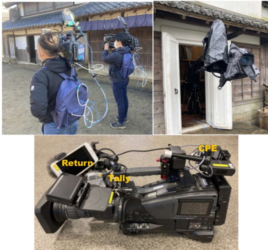
図 4-34 カメラの状況(上左:移動カメラ、上右:クレーンカメラ、下:移動カメラ実装状態)
