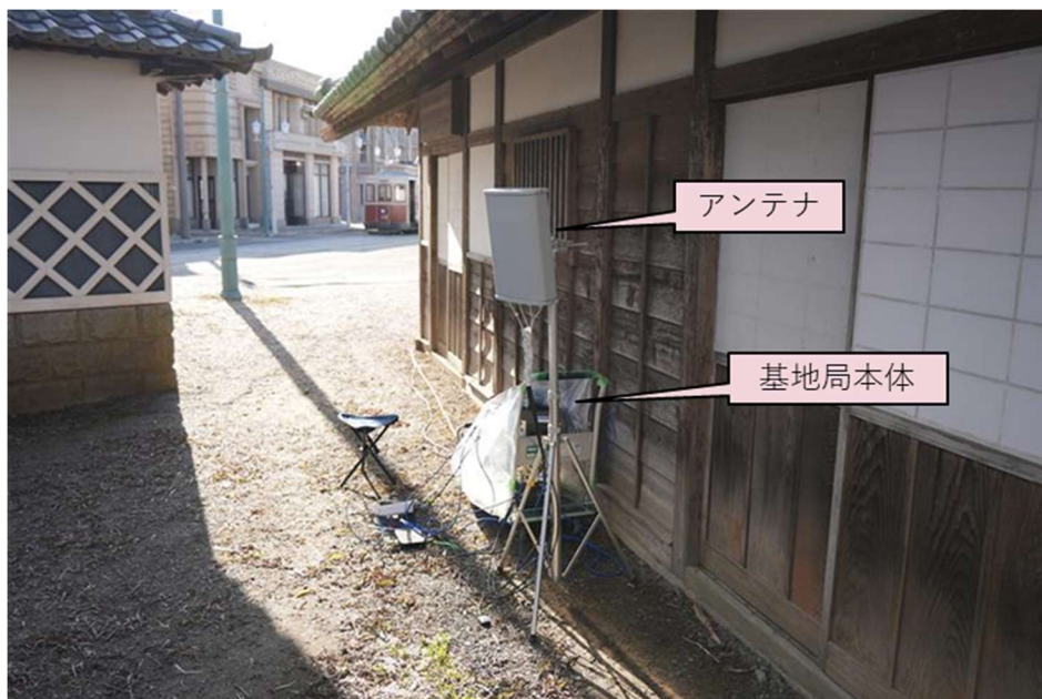
図 2-19 同期基地局設置(実施環境に即する)- 撮影準備室前設置
