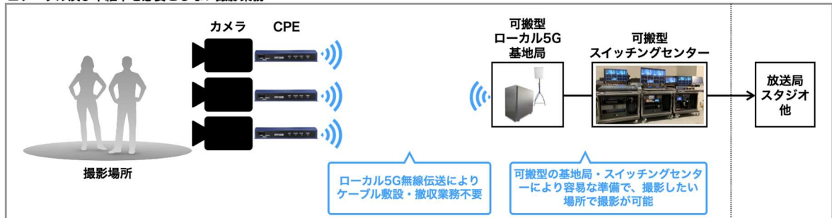
図 4-7 ケーブル及び中継車を必要としない撮影業務の合理化・高度化ソリューション概要
