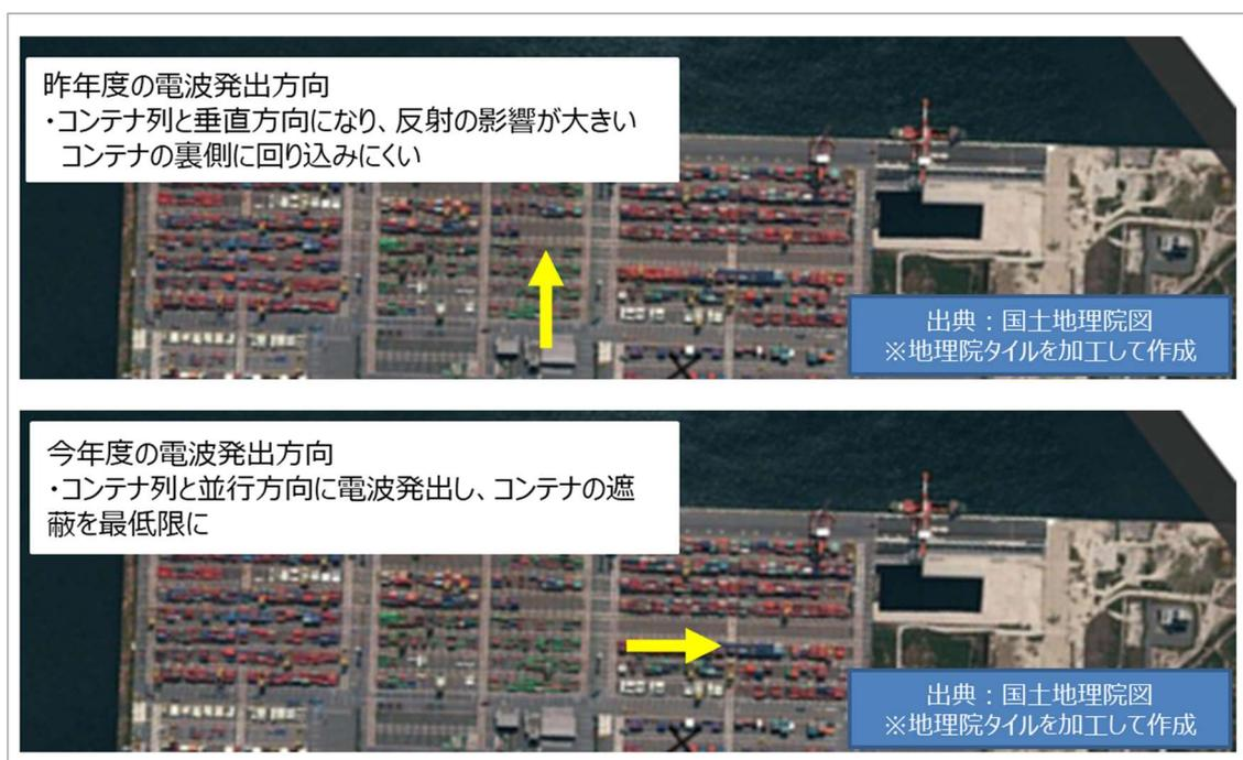
図 3.1-1 基地局構築の方向性
