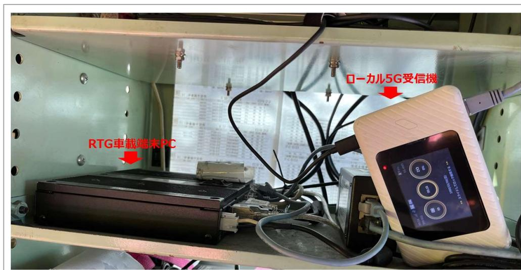
図 4.3-58 RTG 車載端末 PC とローカル 5G 受信機の接続状況
