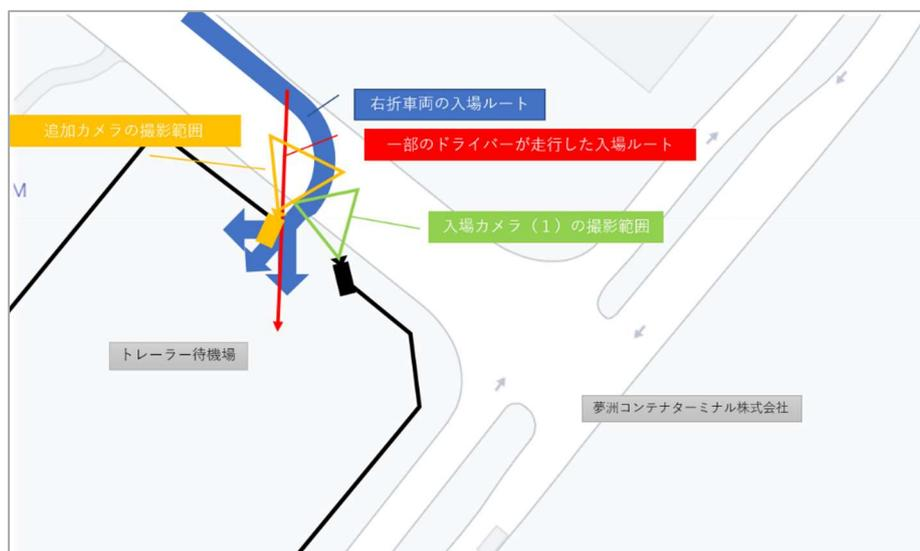
図 4.3-113 追加カメラの設置イメージ(入場ゲート)
