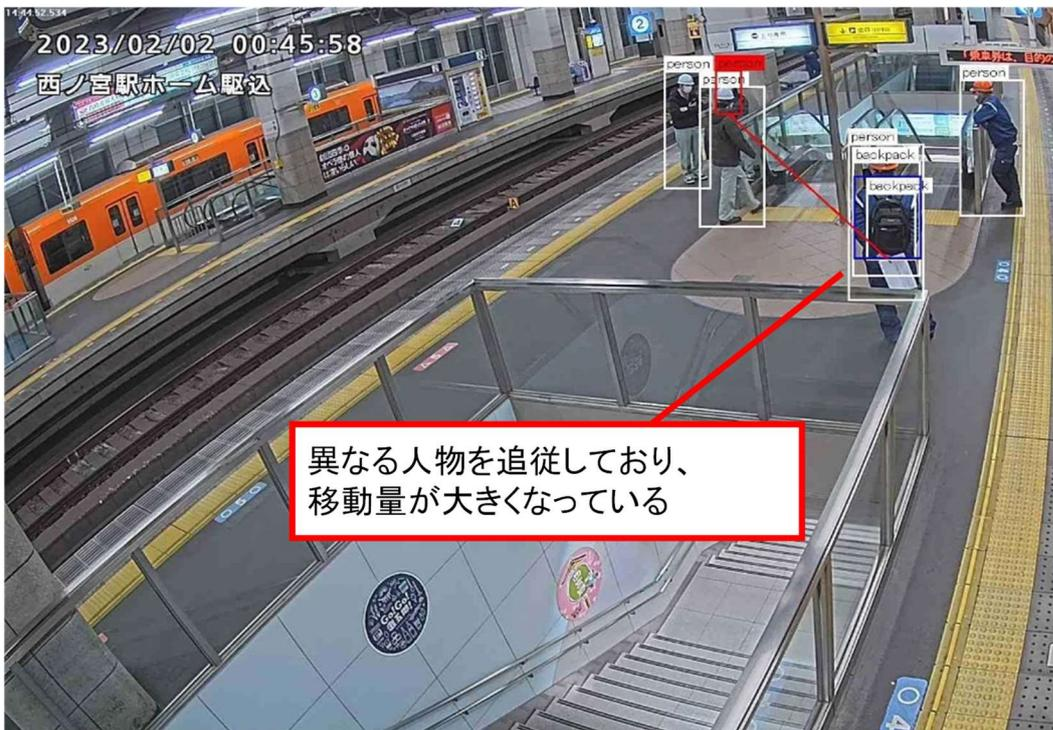
図 4.3.1-20 誤検知の例(駆込み乗車)
