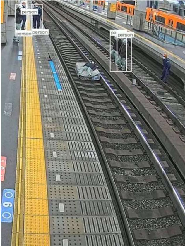
図 4.3.1-17 検知漏れの例(ホームからの人の転落)
