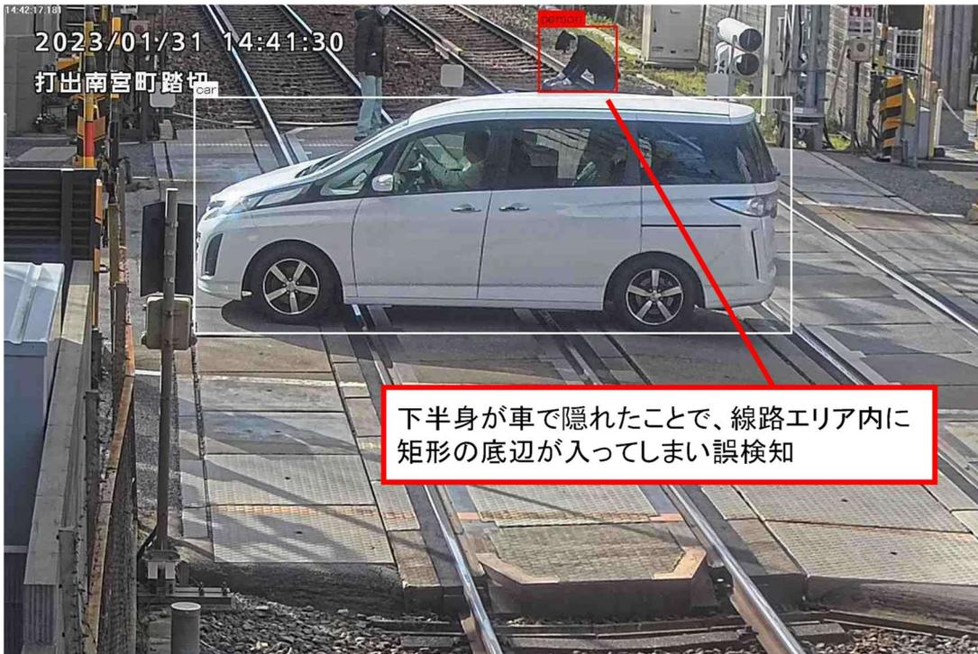
図 4.3.1-13 誤検知の例(線路内への人の侵入)
