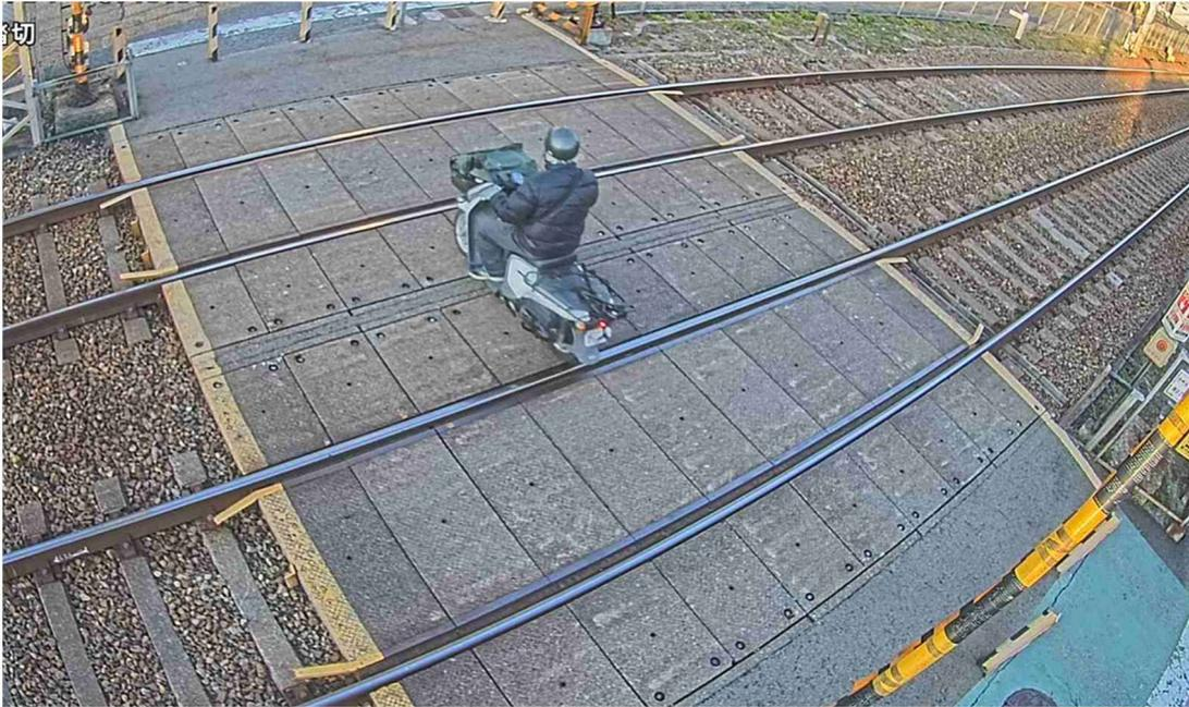
図 4.3.1-15 検知漏れの例(踏切内の二輪車の通行)
