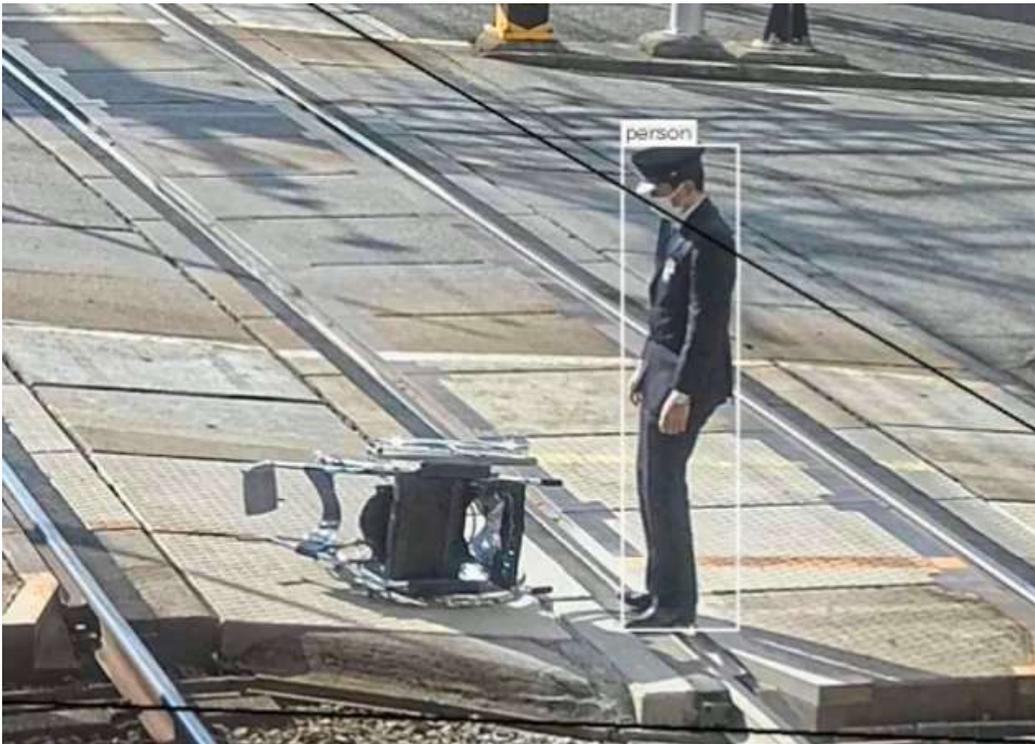
図 4.3.1-16 検知漏れの例(転倒状態の車いす)
