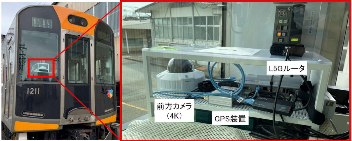
図 4.3.1-32 列車への機器設置の様子
