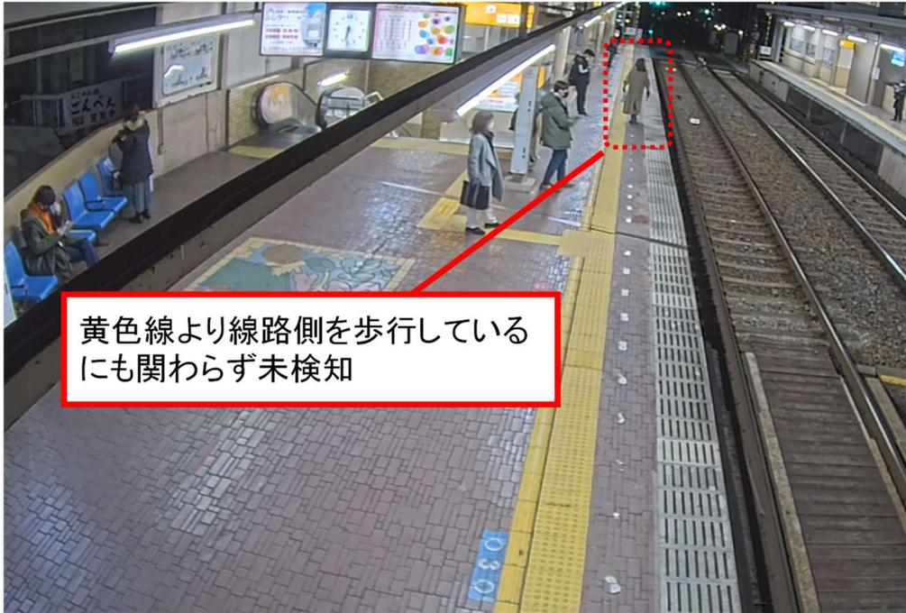
黄色線より線路側を歩行しているにも関わらず未検知
