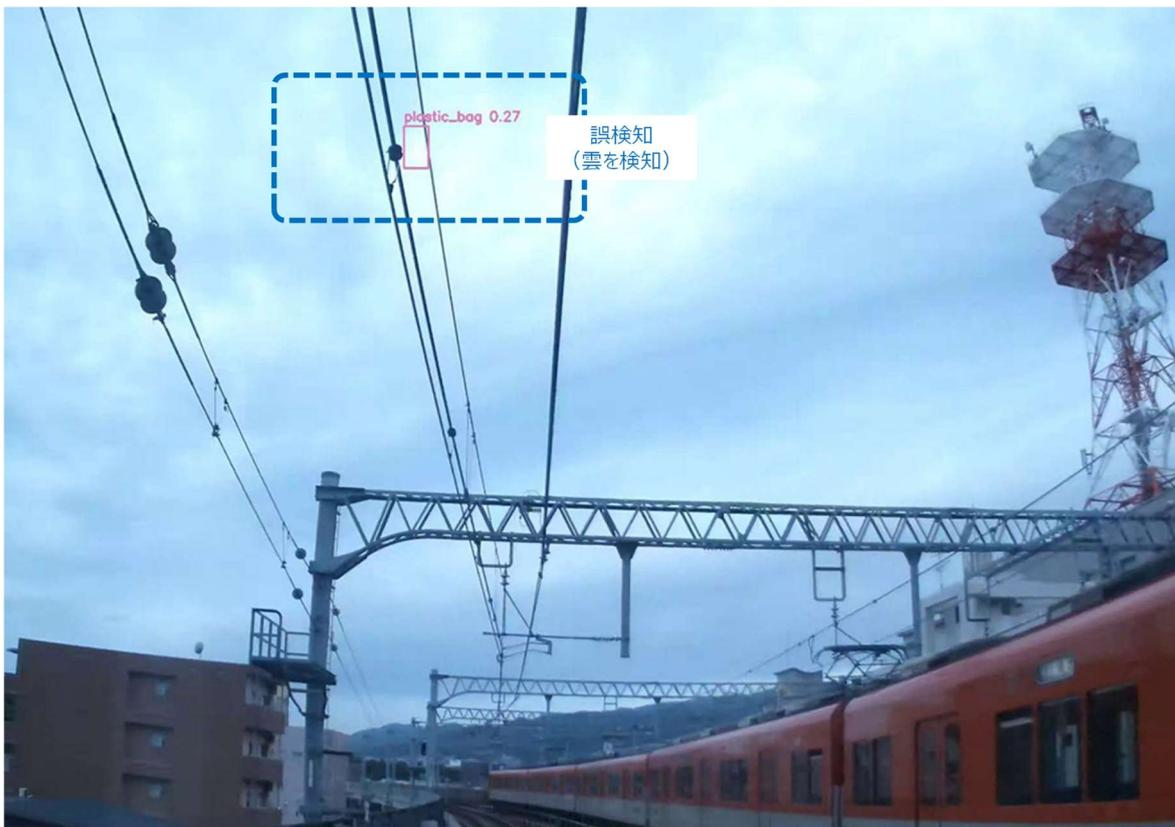
図 4.3.1-31 検知結果の例(背景の雲を誤検知)
