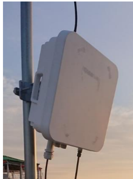
無線部(RRU)外観
