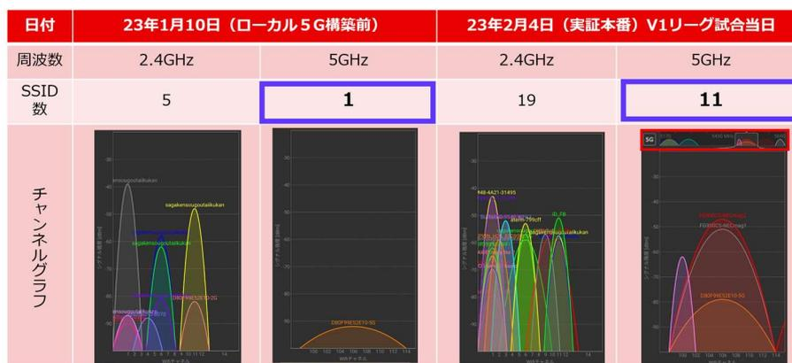
図 4.3-11 V1リーグ試合当日のWi-Fi使用状況(2.4GHz帯・5GHz帯)
