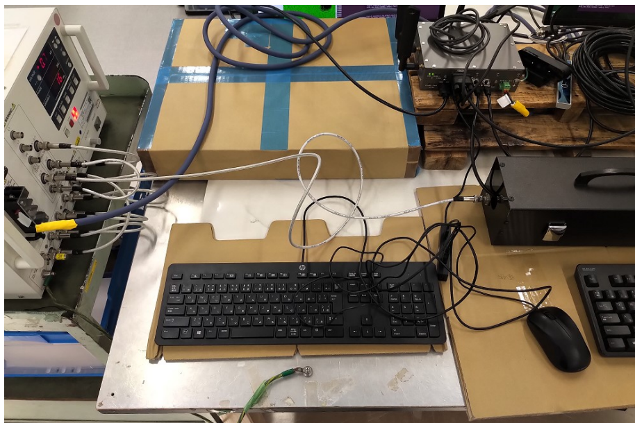
図 4.3.51 通信線のインパルスノイズ耐性試験の検証風景
