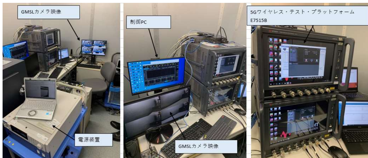
図 4.3.44 試験設備 (電源装置、5G テスター)
