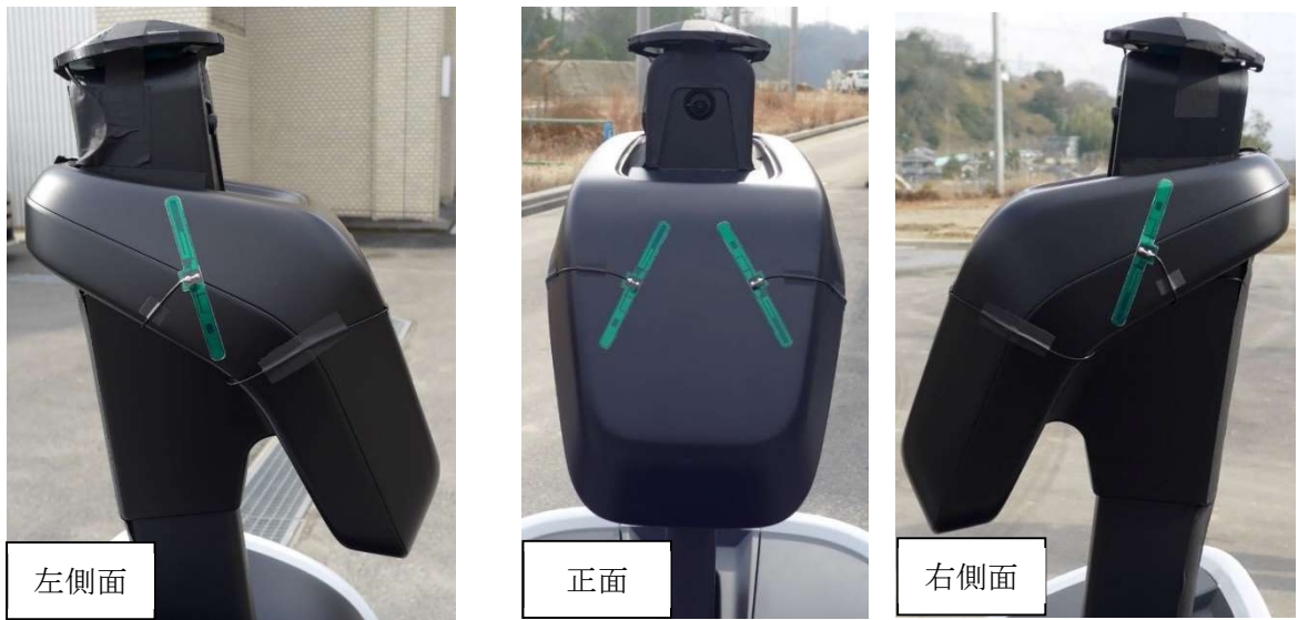
図 4.3.57 遠隔操作ロボット（車いす型）に設置したアンテナ
