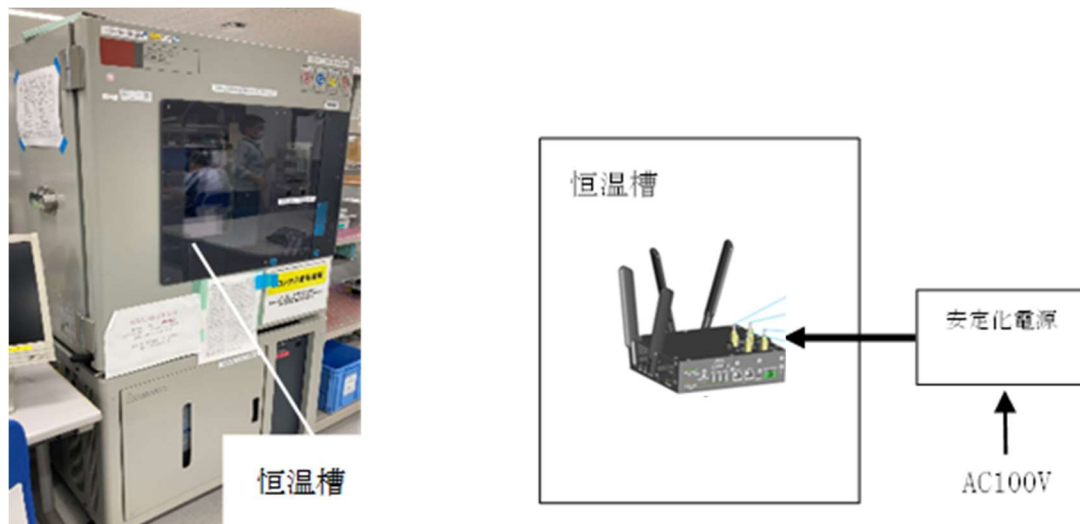
図 4.3.16 高温放置・低温放置試験系
