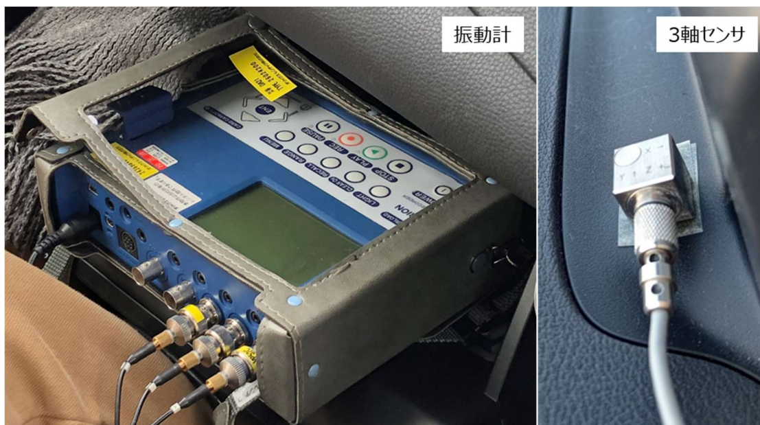
図 4.3.29 振動計及び3軸センサを車両に設置した様子
