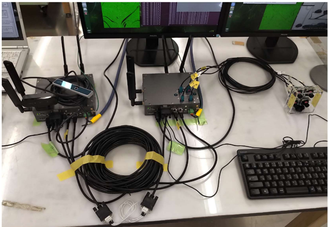
図 4.3.55 静電気試験の検証風景
