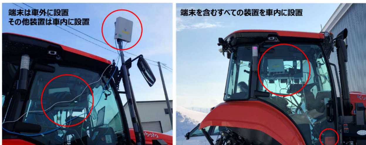
図 4.1.17 令和 2 年度の実証での自動運転トラクターへの装置実装の様子
