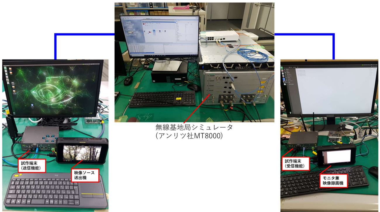
図 4.3.38 ローカル 5G 環境を用いた検証環境 (Uplink のみ無線)
