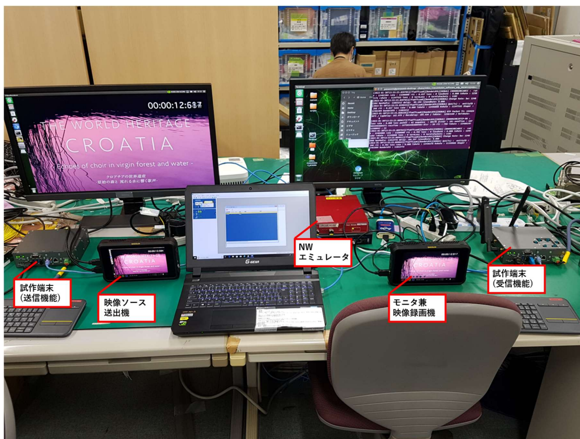
図 4.3.34 ネットワークエミュレータを用いた検証風景
