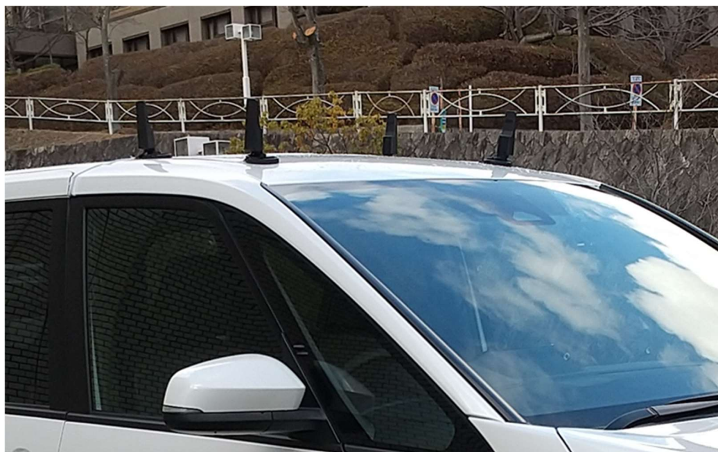
図 4.3.60 車両に設置したアンテナ
