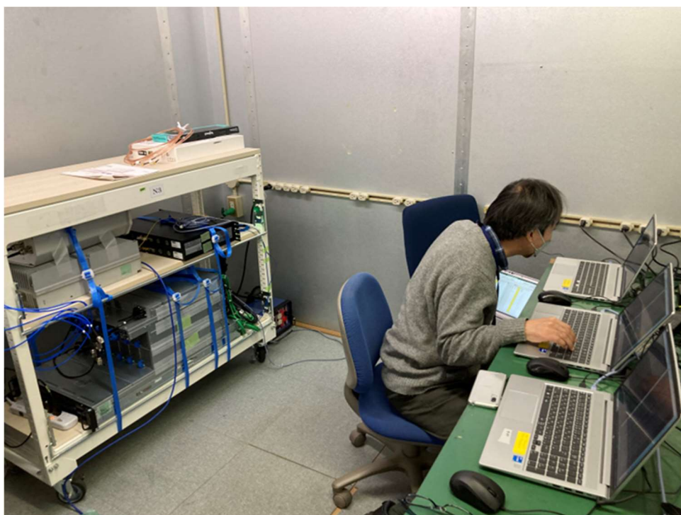
図 3.3.6 検証用基地局を用いた Ping での伝送遅延時間測定風景
