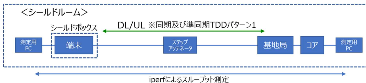
図 3.3.1 検証用基地局でのスループット測定系
