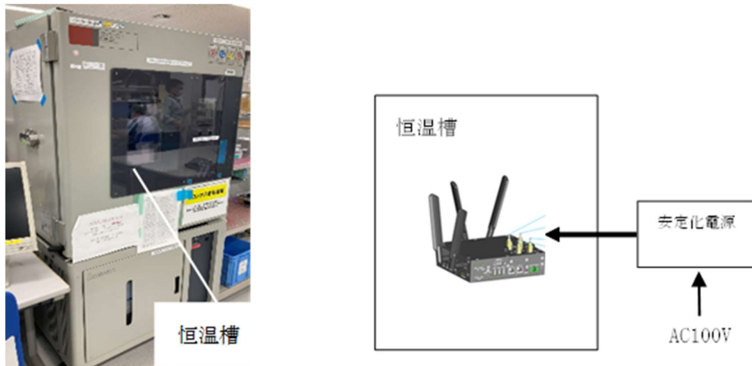
図 4.3.13 高温動作・低温動作試験系
