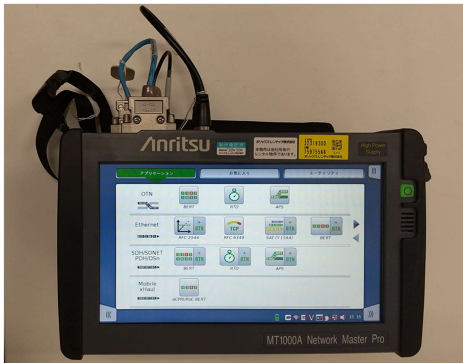
図 3.2.3 ネットワーク遅延測定装置
