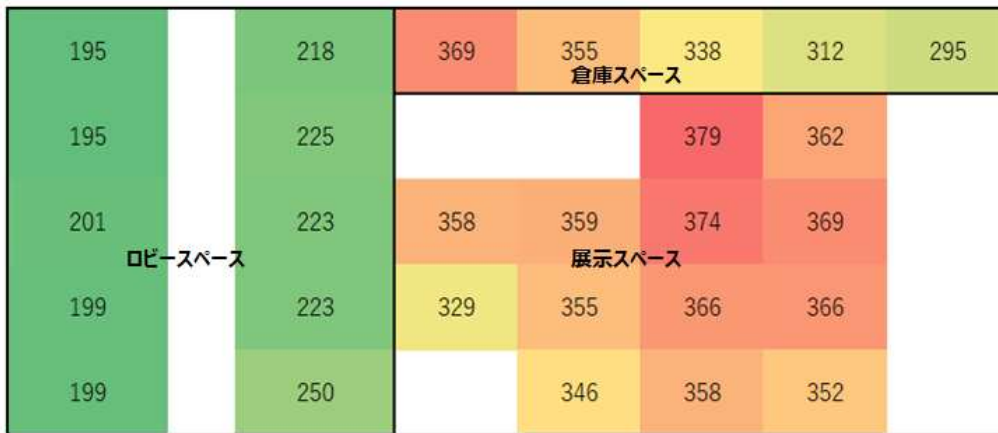
図 4-42 実測したダウンリンクスループット(中央値)のヒートマップ [Mbps]
