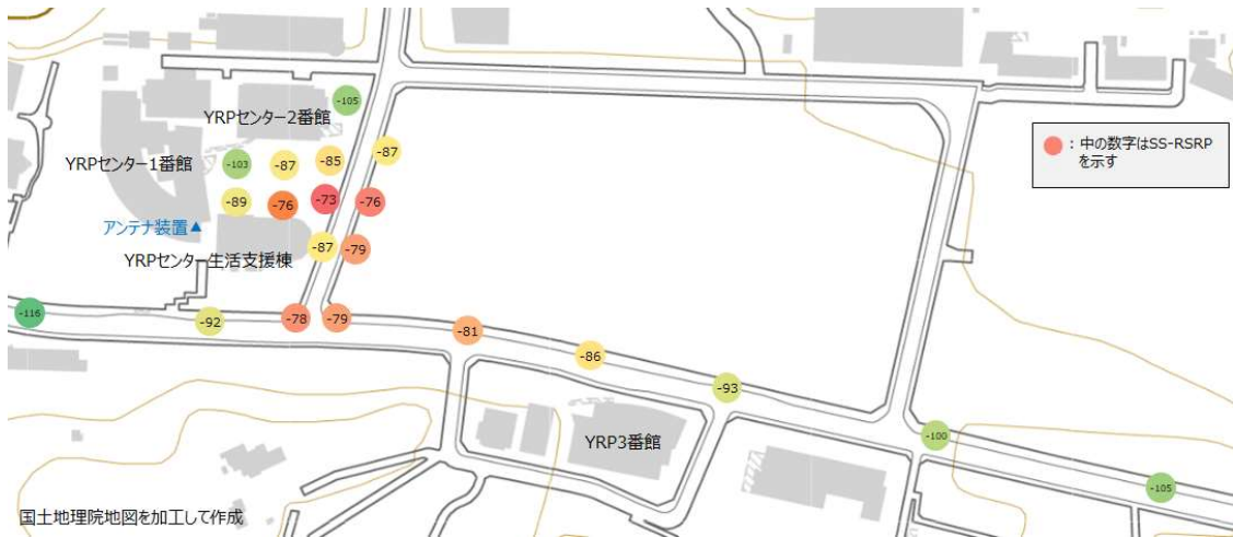
図 3-21 テストベッドの測定ポイントでの SS-RSRP
