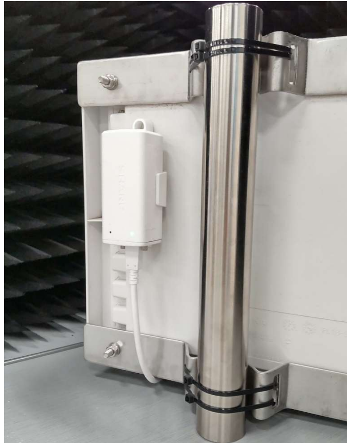
図 4-49 ハウジングケース外に端末システムを設置した状態
