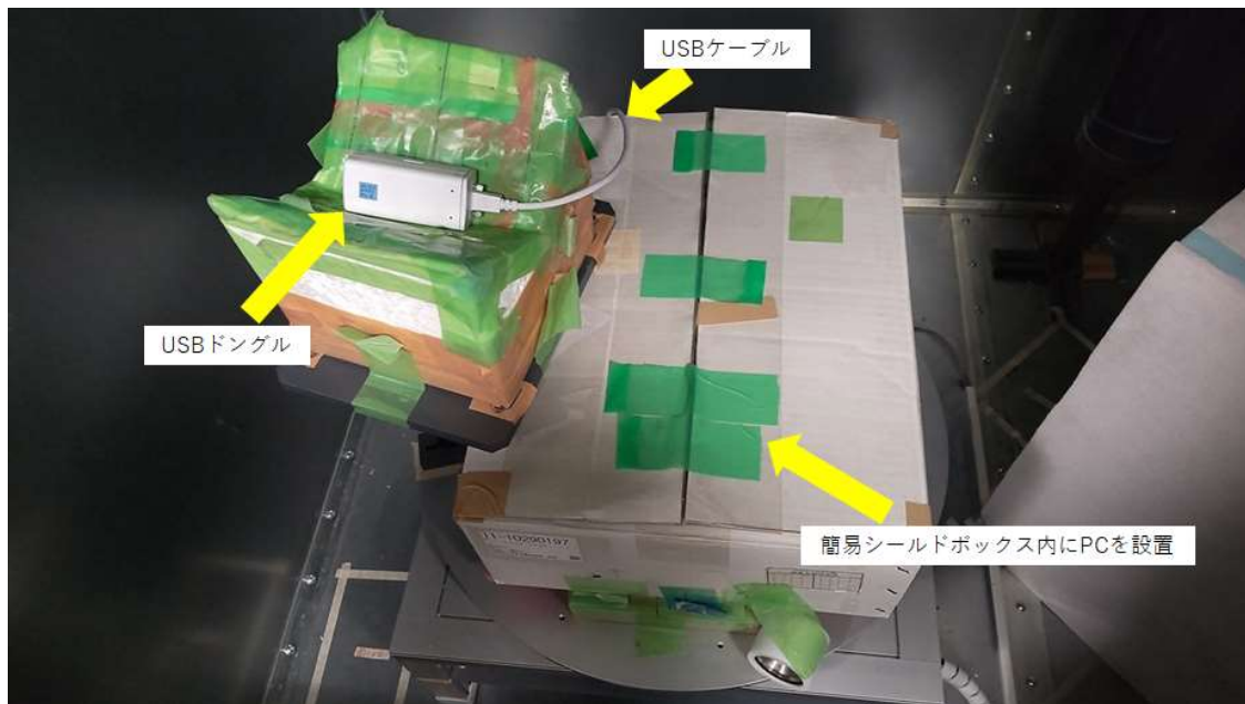
図 4-22 反響チャンバ内の設置の様子
