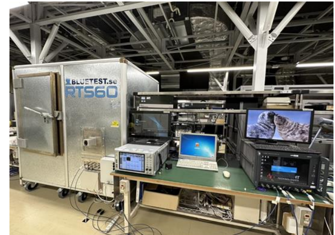
リブレーションチャンバーを用いた、端末システム全体無線性能(OTA・OTAスループット)測定系 一部はストリーミング検証にも使用
