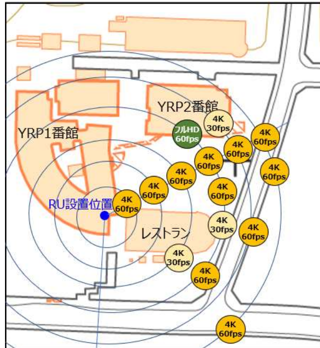
図 3.3-85 準同期 TDD パターン時にフル HD, 4K 映像配信が可能なポイント
