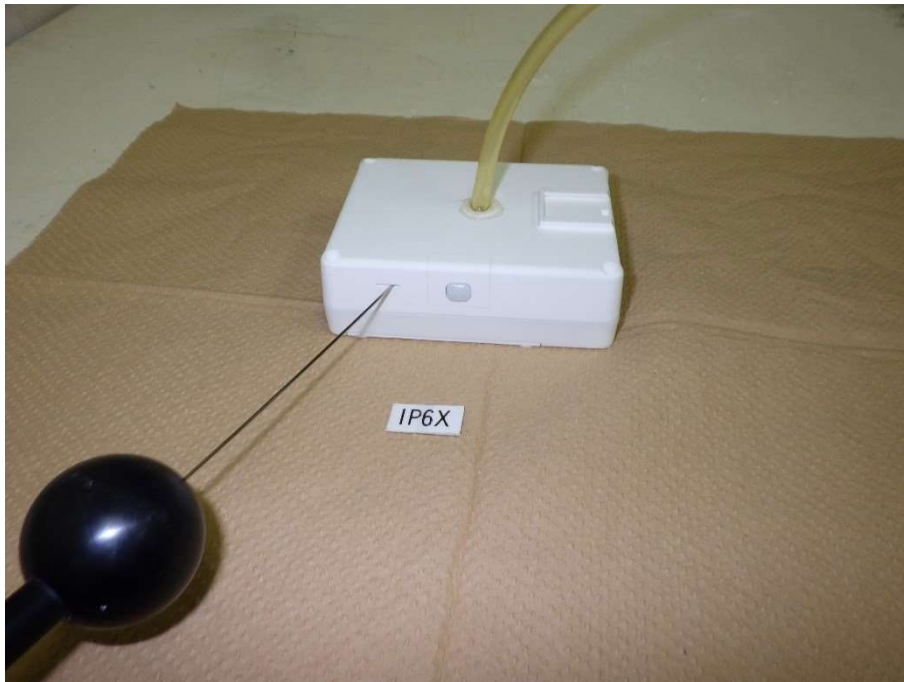
图 4.3-37 IP6X 鋼線試驗
