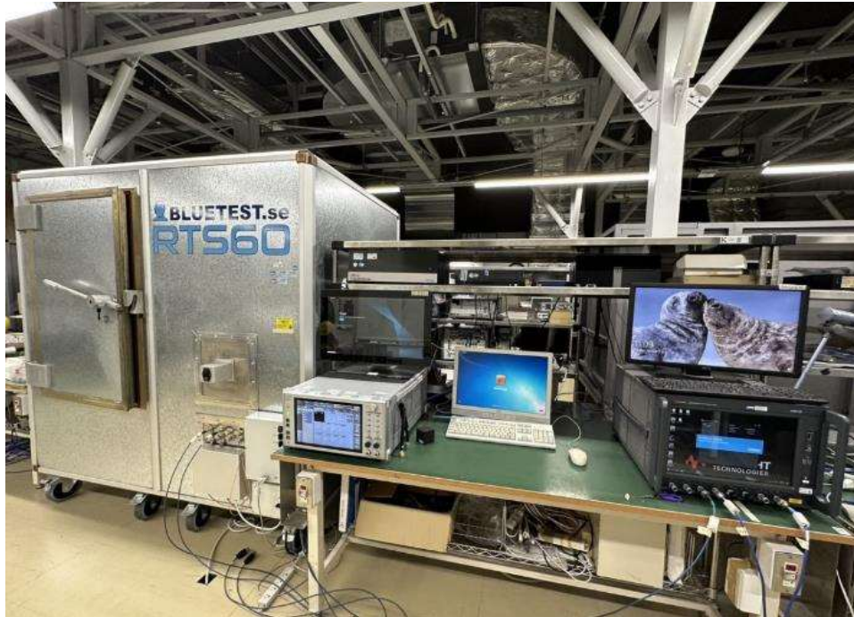
図 2.2-11 FCNT 本社実験室内の OTA 測定環境
