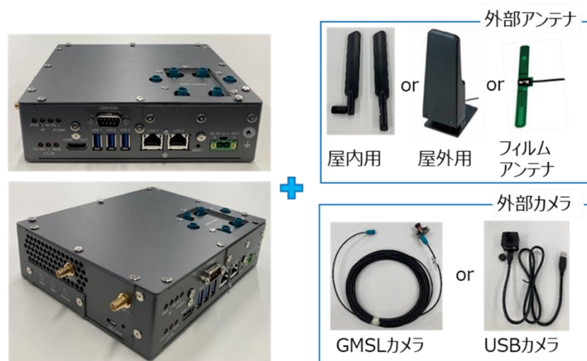
図 6-13 試作端末システムの外観(エンコーダー一体型ルーター端末)
