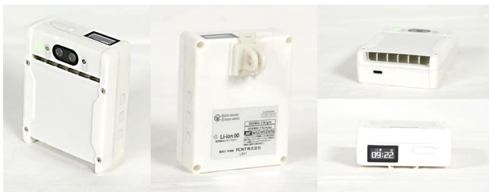
図 6-11 試作端末システムの外観(画質映像ストリーミング対応小型カメラ端末)
