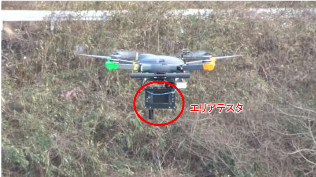
図 3-21 ドローンによる受信電力測定の様子
