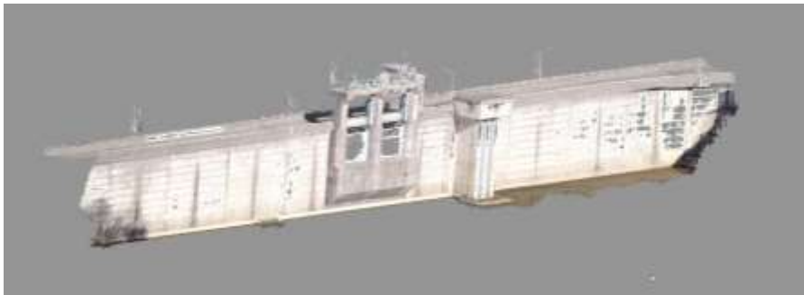
図 4-46 白飛び状態で撮影した動画から作成した 3D データ
