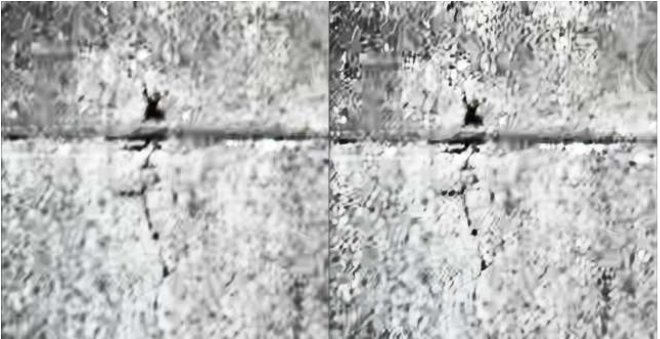
図 4-41 前図からさらにエンハンス効果を高めた超解像処理 (左:ヒストグラム平坦化処理 右:左図からの AI 超解像処理)
