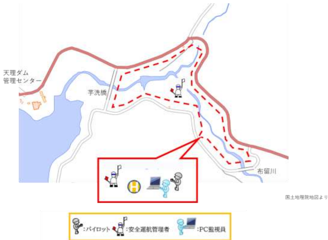
図 4-22 ドローン飛行ルート・エリアおよび人員配置
