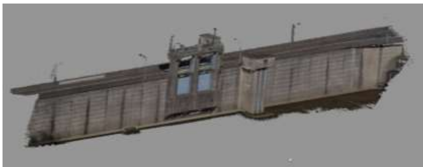
図 4-47 シャッタースピードを速めて白飛びを抑えて撮影した動画から作成した 3D データ
