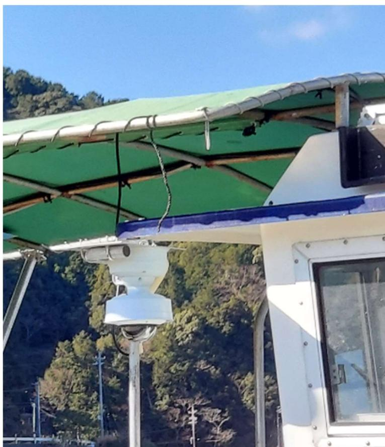
図 4-48 給餌船 活性状況撮影用 4K 高精細カメラ
