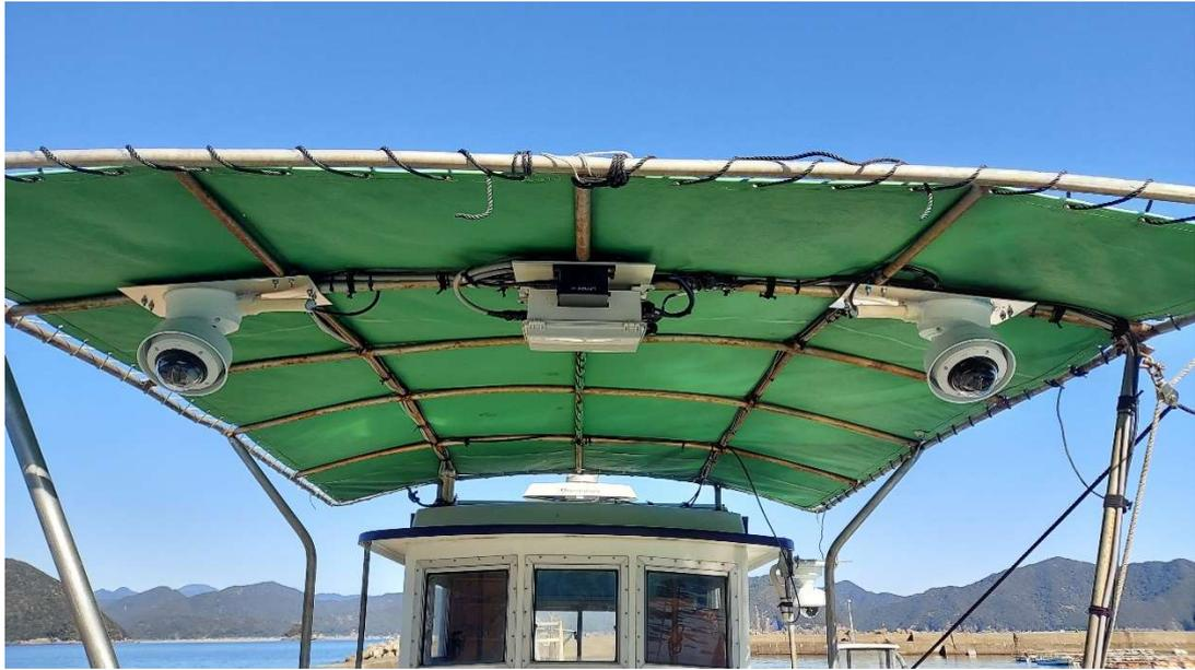
図 4-49 給餌船 操船確認用 4K 高精細カメラ
