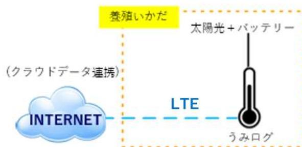
図 4-111 海洋データ取得センサー（うみログ）構成
