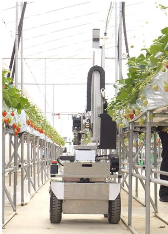
図 2.3.37 イチゴ自動収穫用マニピュレータ 外観
