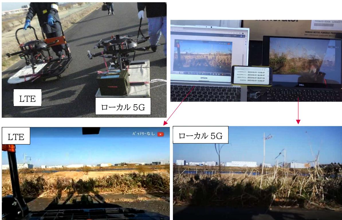
図 4.3-31 定性検証時の状況写真(左上:陸上測定の様子、右上:受信状況の画面比較
