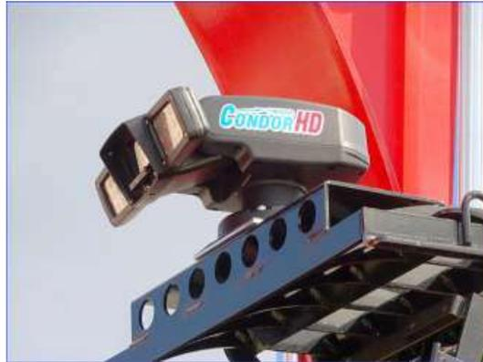
図 2.4-23 カメラ車用旋回 HD カメラ外観
