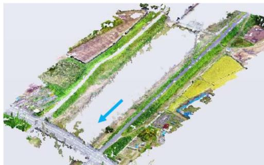
ドローン写真測量による3次元データ
