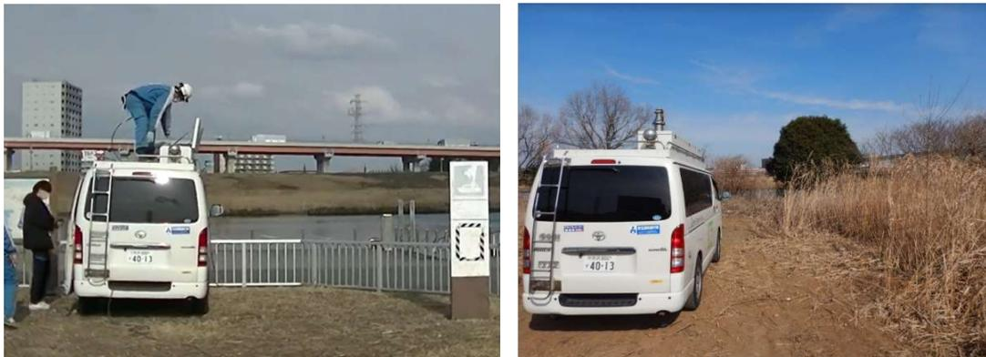
図 4.3-68 ローカル 5G 可搬型基地局設置状況(左:新田緊急用船着場 右:扇大橋上流)
