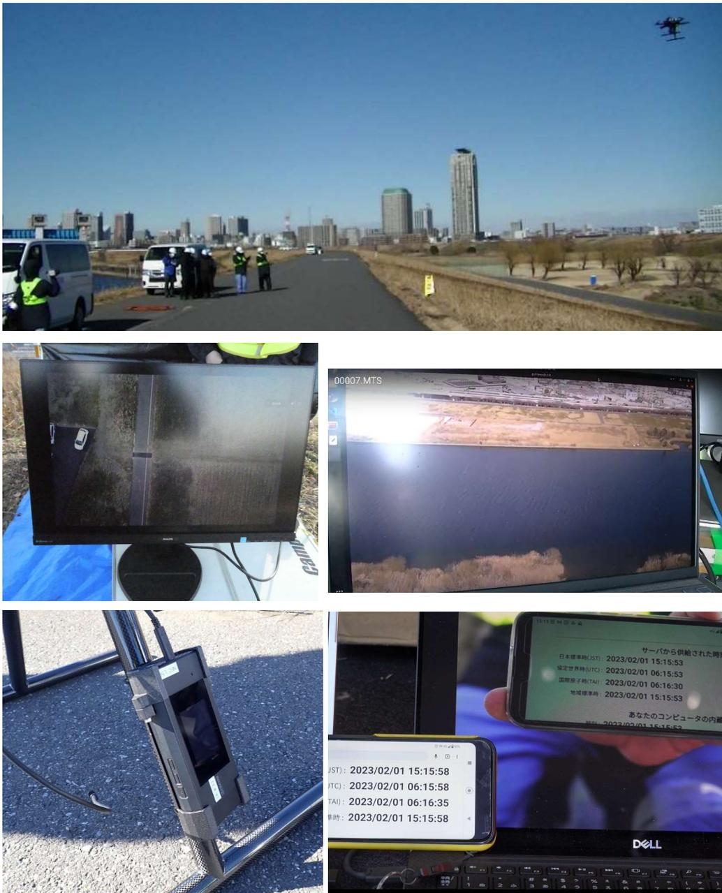
図 4.3-18 ドローンリアルタイム映像配信の状況写真(上:フライト状況、中左:現地作業員 PC 画面、中右:基地局 PC 画面、下左:機体に搭載するローカル 5G 端末、下右:映像遅延の確認状況)
