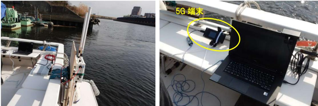
図 4.3-66 船舶上に設置した BWA 通信装置及び PC(左)、ローカル 5G 端末及び PC(右)
