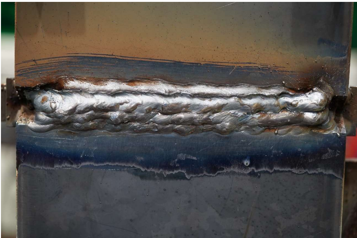
図 4-28 溶接士 B 溶接後外観写真 (1 回目、10 パス)
