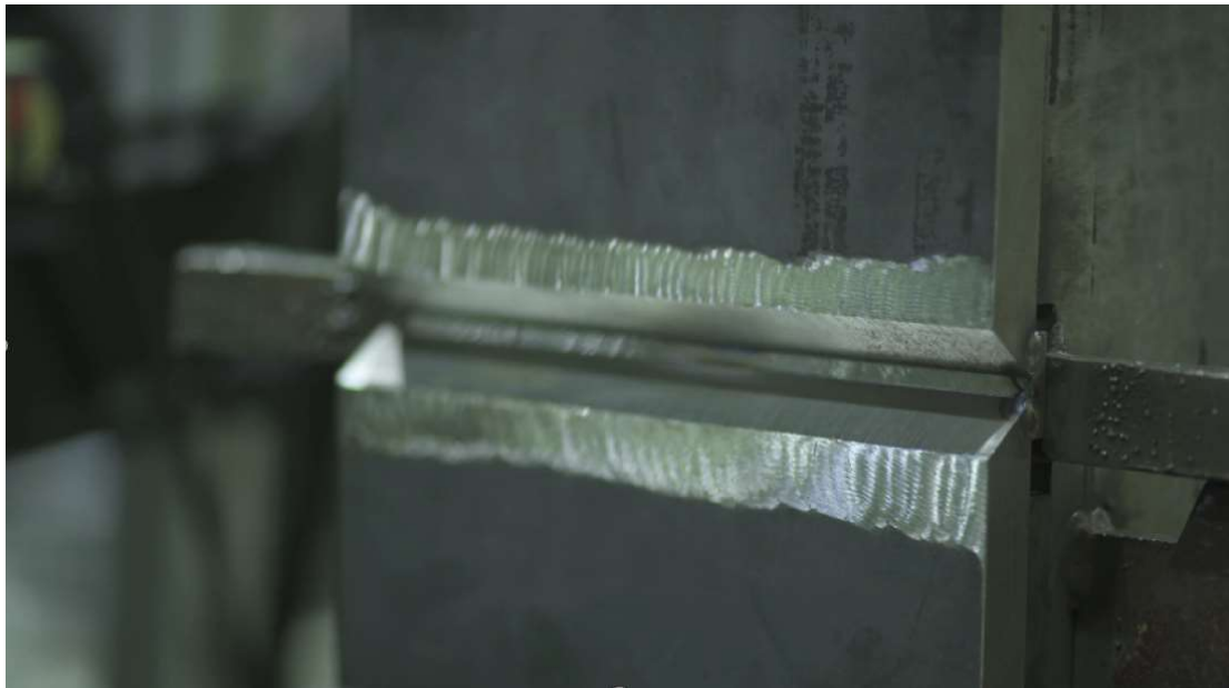
図 4-20 溶接前の試験体
