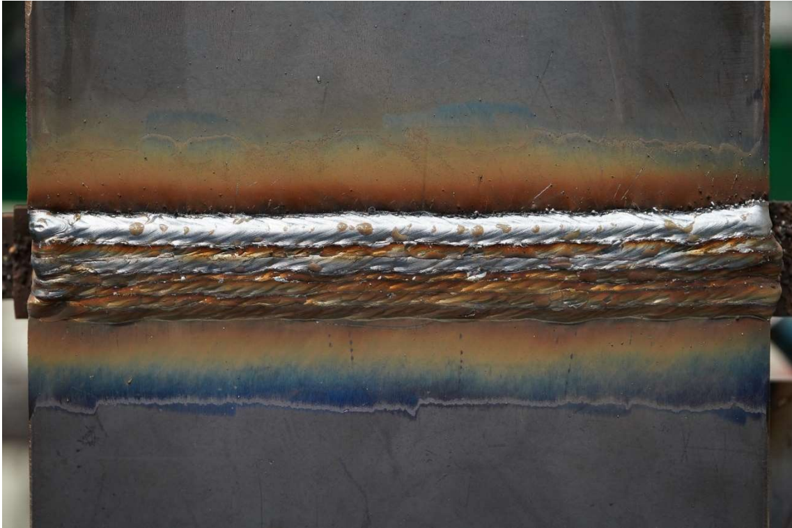
図 4-33 溶接士 F 溶接後写真 (1回目、17パス)
