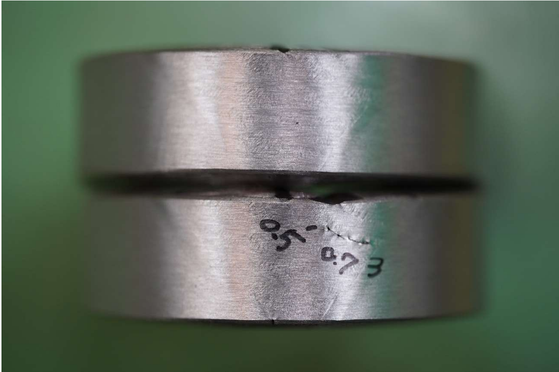
図 4-37 曲げ試験の例 – 不良品 (2) (溶接士 A、5 回目、BT:53.7 点)
