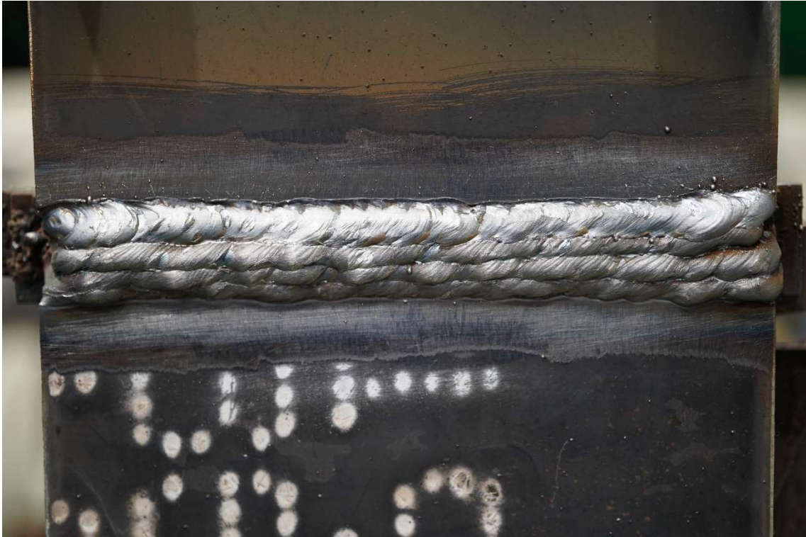
図 4-29 溶接士 B 溶接後外観写真 (9 回目、10 パス)
