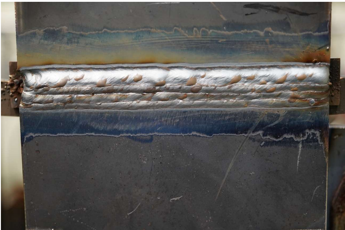
図 4-32 溶接士 E 溶接後外観写真 (1回目、10パス)
