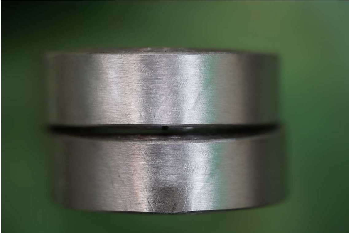
図 4-35 曲げ試験の例 - 良品 (2) (溶接士 C、4 回目、BT:100 点)
