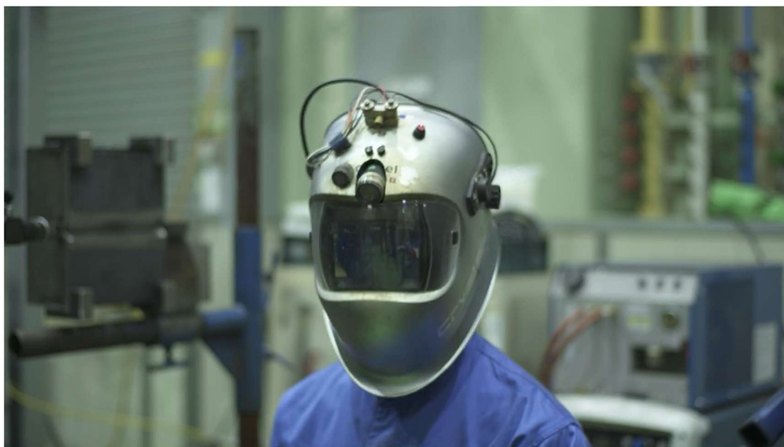
図 4-10 溶接士のヘルメットに設置されたカメラ
