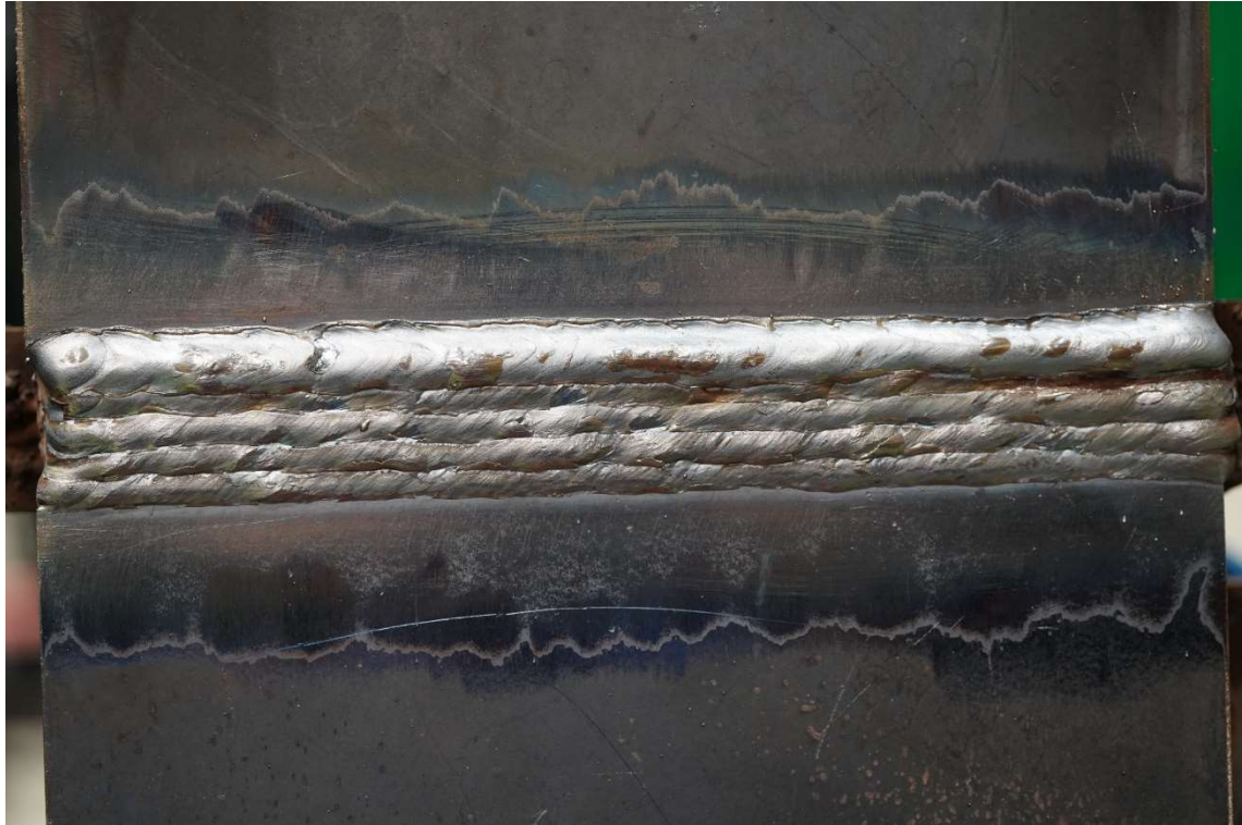
図 4-31 溶接士 C 溶接後外観写真 (4回目、10パス)
