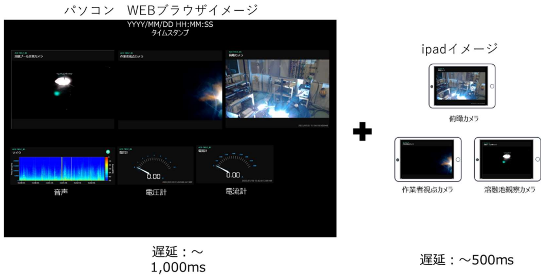
図 4-15 データフュージョンにより表示される UI (ダッシュボード) イメージ
