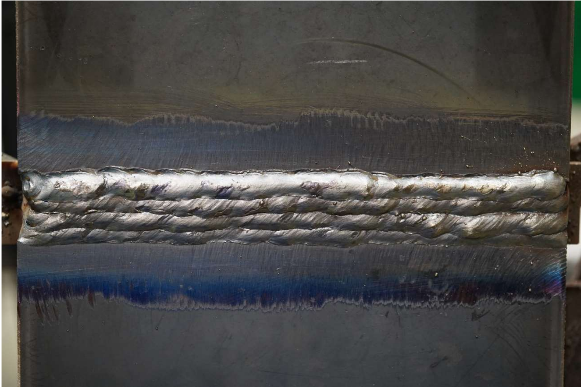
図 4-27 溶接士 A 溶接後外観写真 (8 回目、10 パス)
