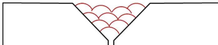
図 4-2 突き合わせ継手の断面図
