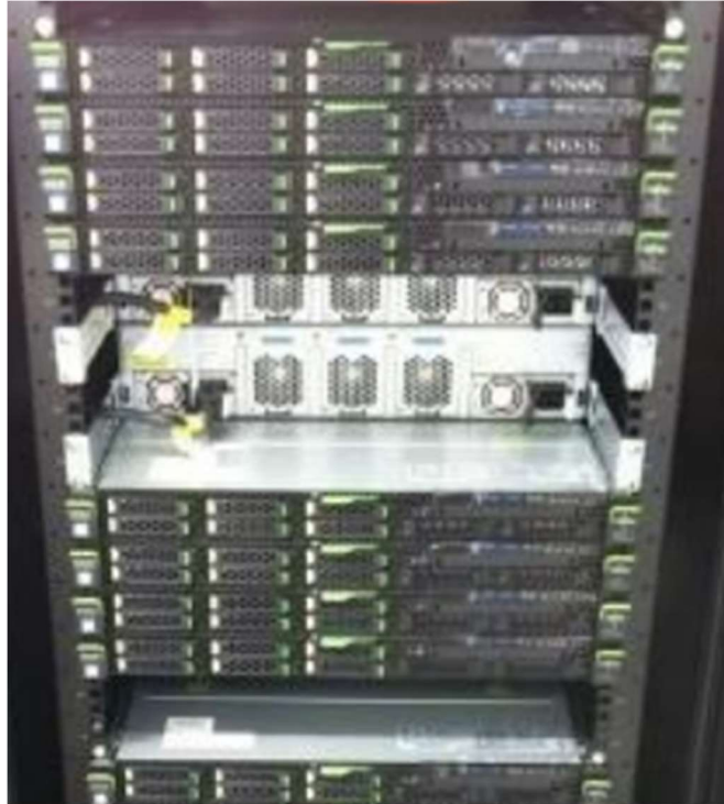
図 2-13 ドコモ 5G の交換機（EPC の一部機能部が実装されたハードウェア）
