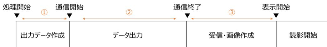
図 4.4.1.2-15 X 線動画伝送装置における処理の流れ
