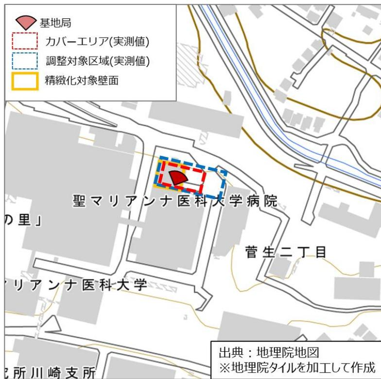
図 3. 3. 2. 5-2(g) 実測値から推定したカバーエリア及び調整対象区域(Tx2)
