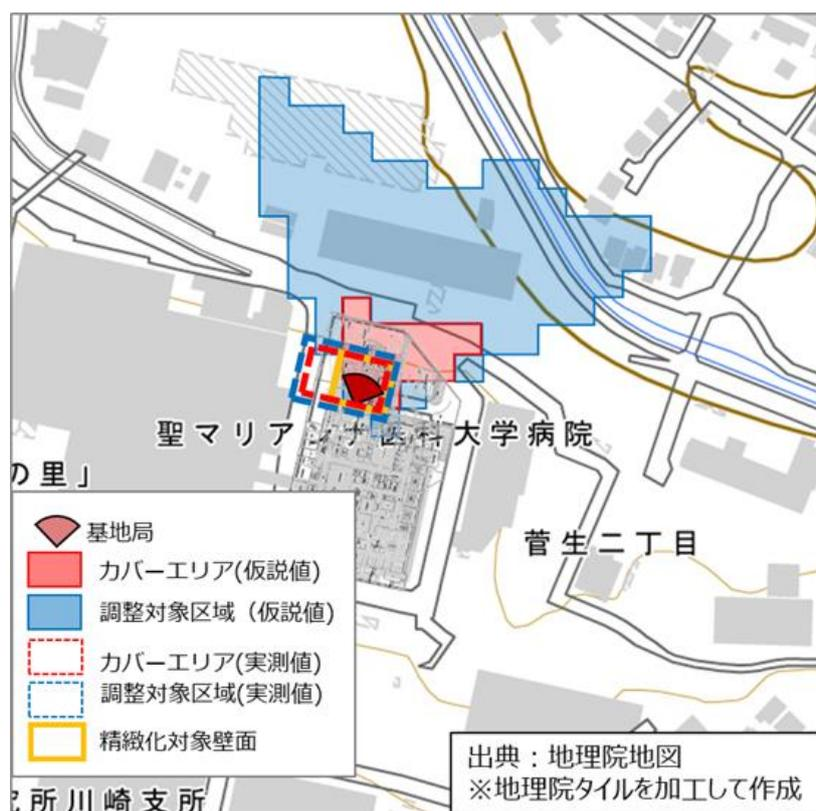
図3.3.2.5-3(a) 仮説値エリア図と実測値推定エリア図との比較(Tx1)
