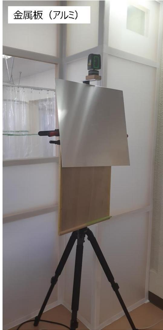
図 3. 3. 3. 5-2(a) 実証に用いた電波反射板
