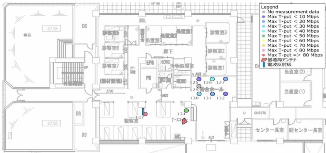
図 3.3.3.5-9(b) 金属反射板設置後設置後の伝送スループット (UL) 測定結果
