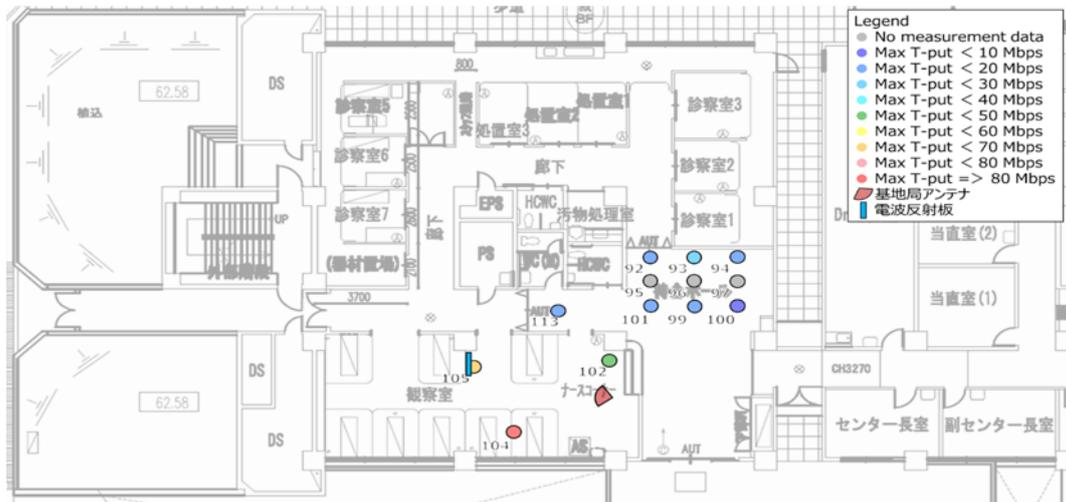
図 3. 3. 3. 5-8(b) メタマテリアル反射板設置後の伝送スループット (UL) 測定結果
