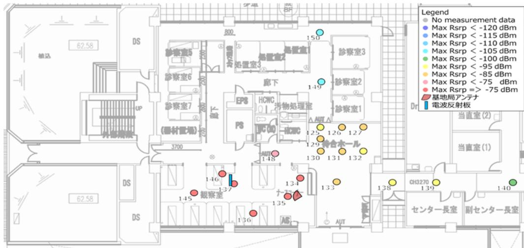
図 3.3.3.5-3(c) 金属反射板設置後の SS-RSRP 測定結果 (屋内)
