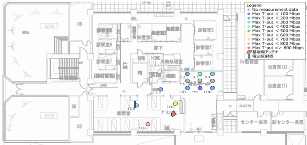
図 3. 3. 3. 5-8(a) メタマテリアル反射板設置後の伝送スループット (DL) 測定結果
