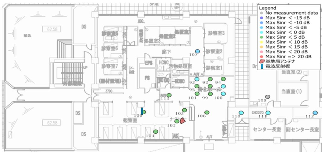
図 3.3.3.5-4(b) メタマテリアル反射板設置後の SS-SINR 測定結果 (屋内)
