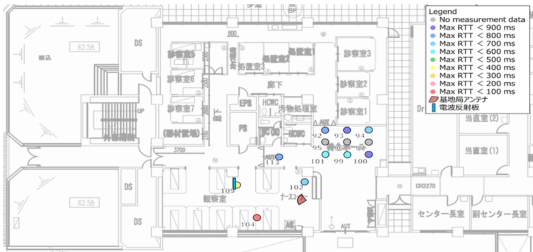
図 3. 3. 3. 5-8(c) メタマテリアル反射板設置後の伝送スループット RTT 測定結
