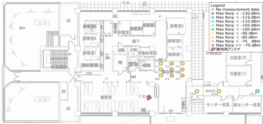
図 3.3.3.5-3(a) 電波反射板設置前の SS-RSRP 測定結果 (屋内)
