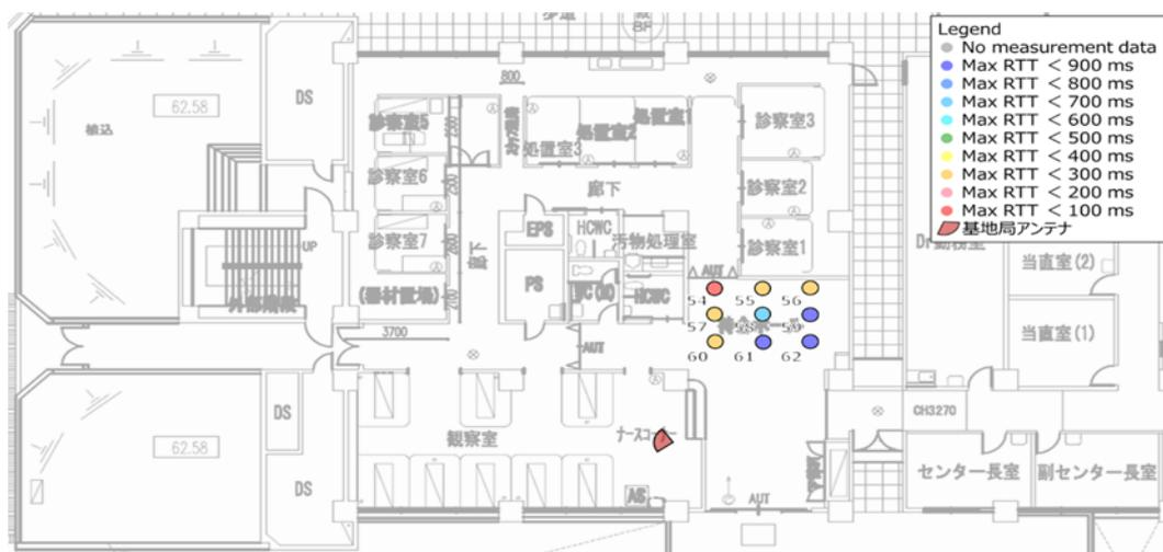
図 3.3.3.5-7(c) 電波反射板設置前の伝送スループット RTT 測定結果
