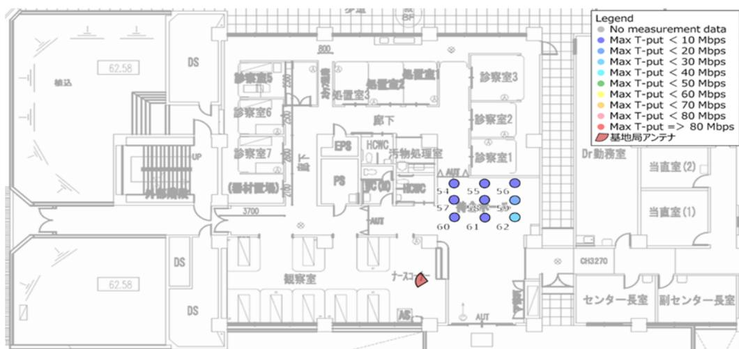
図 3.3.3.5-7(b) 電波反射板設置前の伝送スループット (UL) 測定結果
