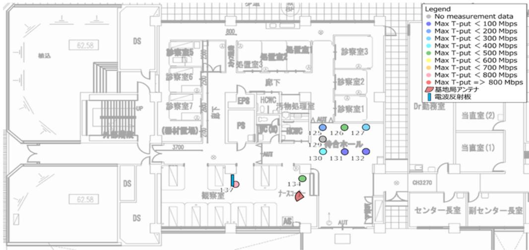
図 3.3.3.5-9(a) 金属反射板設置後の伝送スループット (DL) 測定結果
