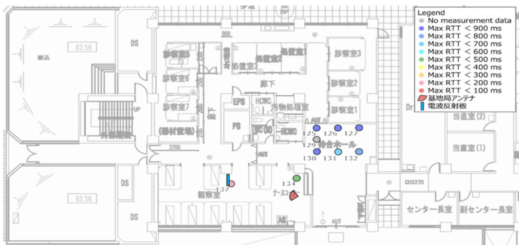
図 3.3.3.5-9(c) 金属反射板設置後の伝送スループット RTT 測定結果
