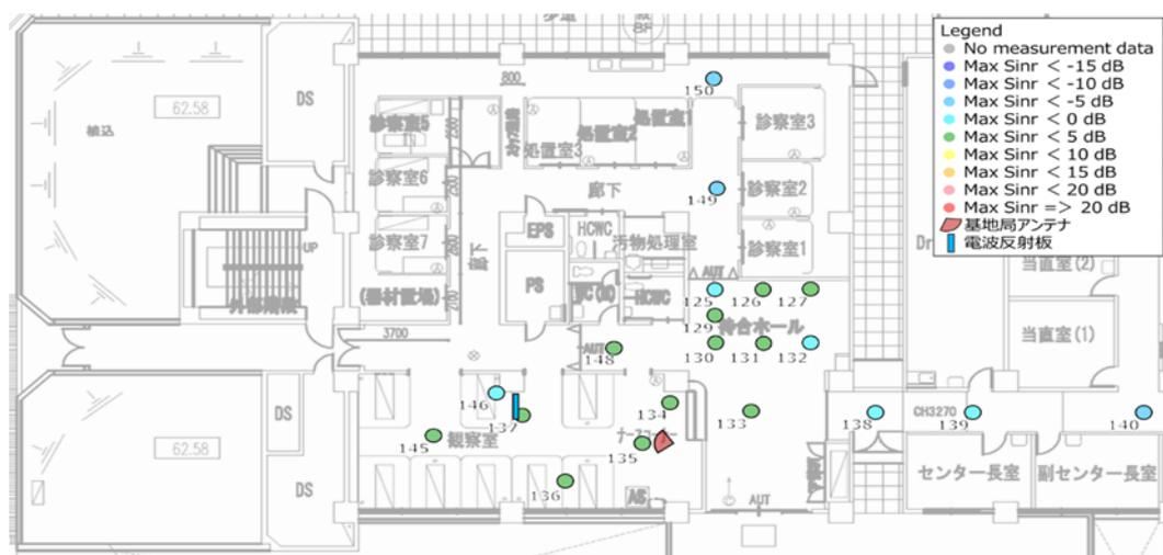
図 3. 3. 3. 5-4(c) 金属反射板設置後の SS-SINR 測定結果 (屋内)
