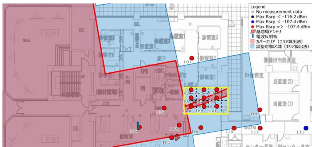
図 3.3.3.5-15(a) メタマテリアル反射板設置後における仮説エリア図との比較 (屋内)
