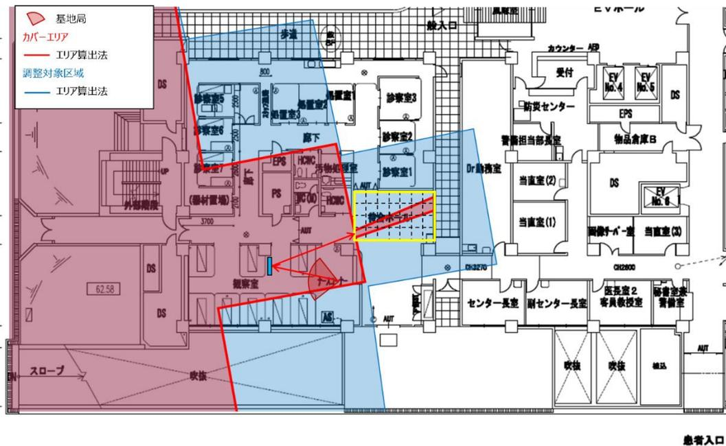
図 3.3.3.2-3 メタマテリアル設置時におけるエリア図
