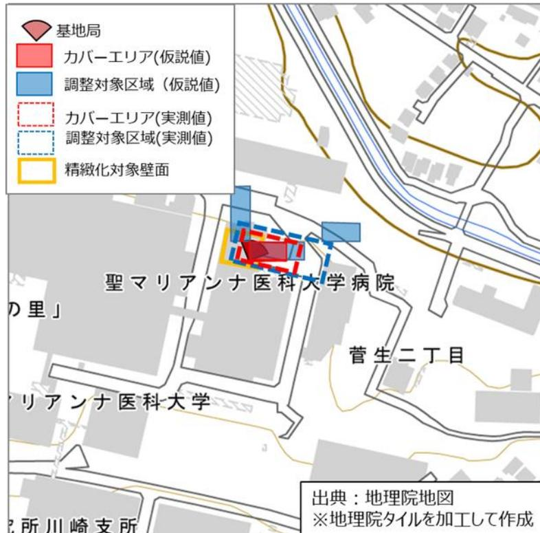
図 3. 3. 2. 5-3 (b) 仮説値エリア図と実測値推定エリア図との比較(Tx2)
