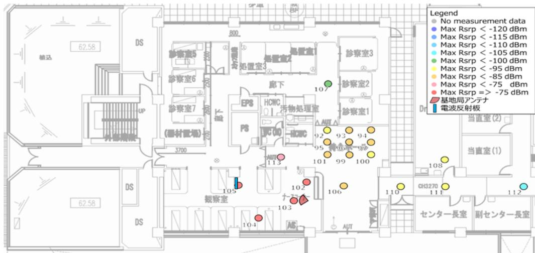
図 3.3.3.5-3(b) メタマテリアル反射板設置後の SS-RSRP 測定結果 (屋内)
