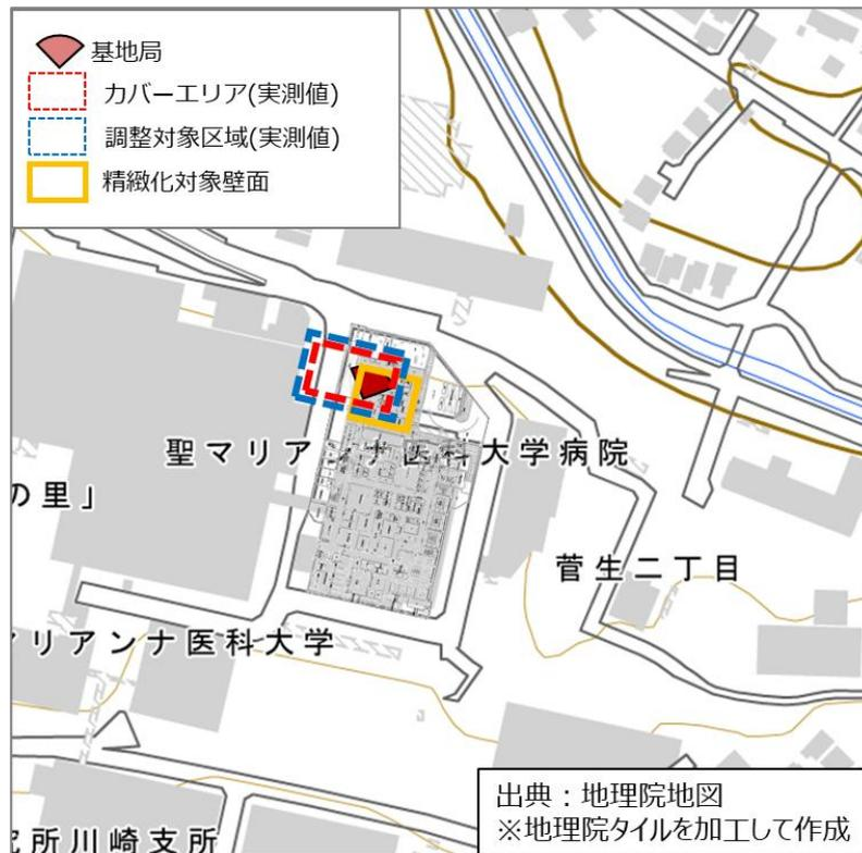
図 3.3.2.5-2(d) 実測値から推定したカバーエリア及び調整対象区域(Tx1)
