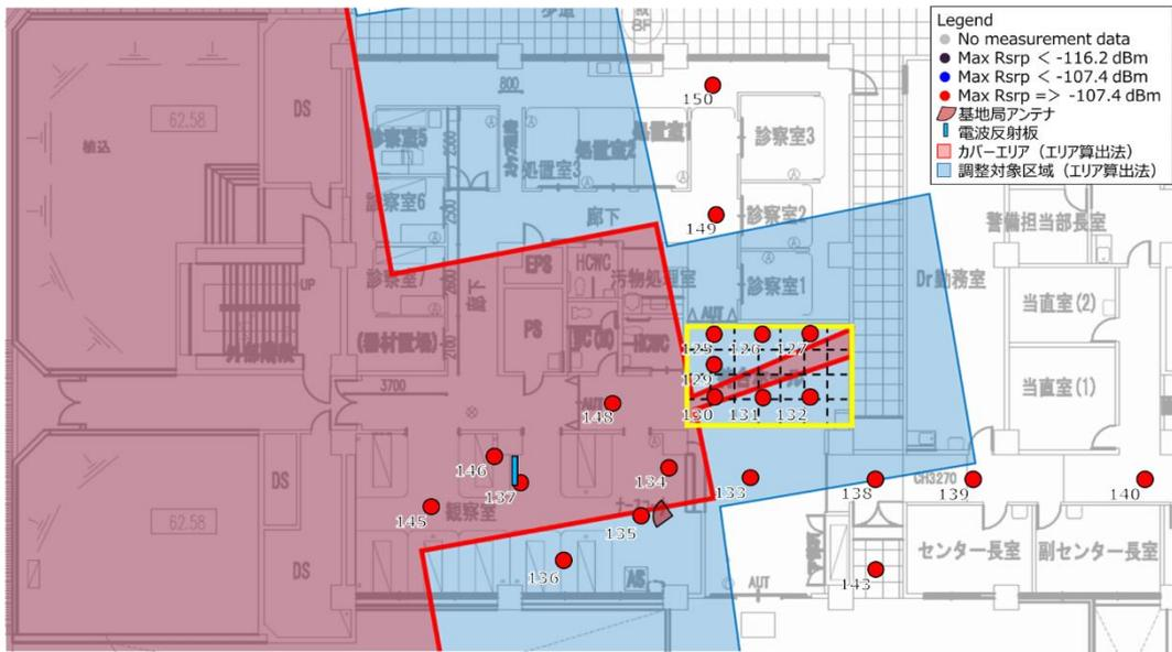
図 3. 3. 3. 5-17(a) 金属反射板設置後における仮説エリア図との比較（屋内）
