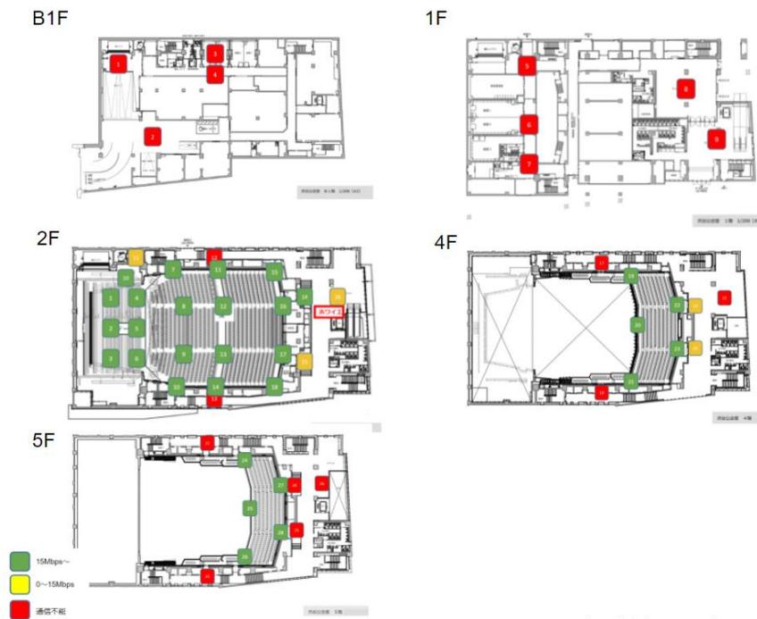
今回の計測により、業務範囲と定義した客席の内側・ステージ上においては要求性能に十分な伝送性能が得られるが、ホール外に出ると著しく通信品質が低下することが判明した。これはコンサートホールという建物の特性上、音を漏らさないための二重ドアや壁の構造・材質などが要因になっていることが原因として考えられる。
