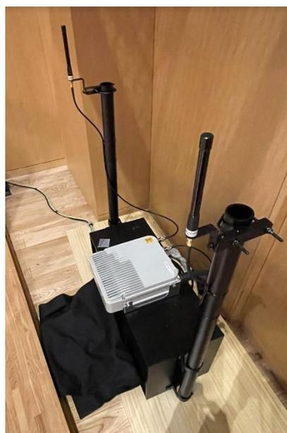
図 2.2.4 GPS アンテナの設置位置の様子
