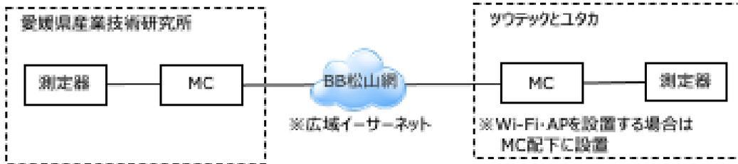
図 3-239 光回線構成
