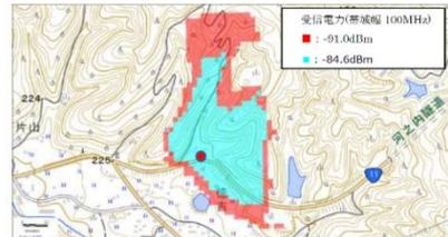
図 3-4 ツウテック株式会社シミュレーション (屋内浸透なし)
