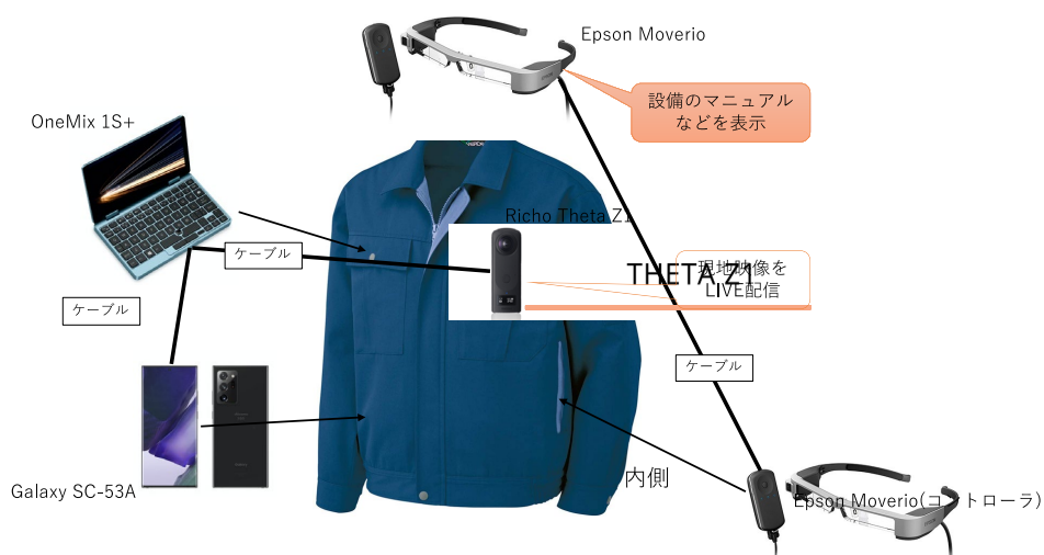
図 4.4-44 現地作業員の機器装着イメージ
