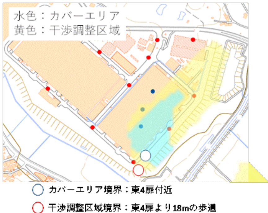
図 5-86 評価エリア B の基地局のカバーエリアと干渉調整区域の測定結果
