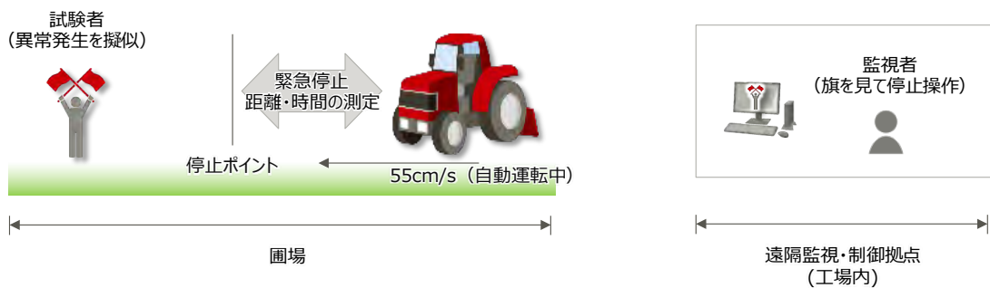
図 4. 3. 1-4. 3-23 緊急停止時間の測定方法
