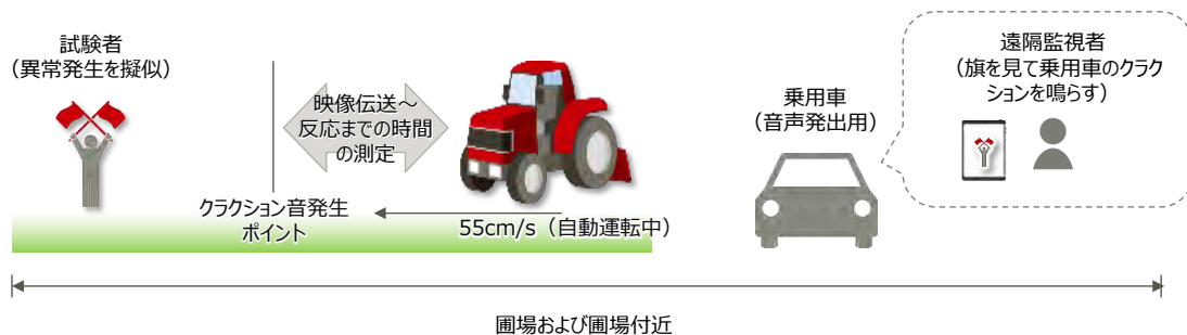
図 4.3.1-4.3-42 従来システムの測定方法
