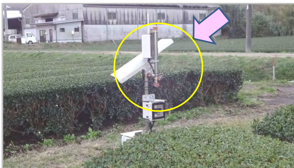
図 4.1.3-2 LPWA カメラの設置写真-子機及びカメラ
