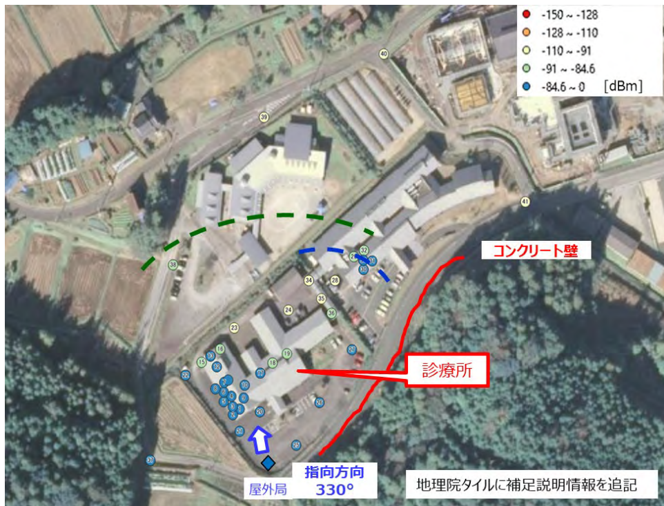
図 5.4.3-7(b) 受信電力実測値からの屋外エリア推定図 新城診療所屋外エリア
