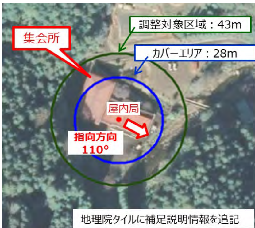
図 5.4.3-5(b) 屋内基地局送信電力値から建物侵入損分を最引いた電力値で描いたエリア図
