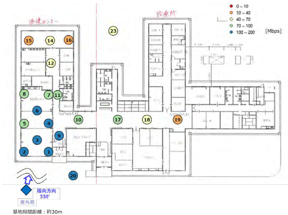
図 5.3.5-9(b) 屋内の測定結果（再掲）診療所屋外局周辺での伝送スループット（UL）測定結果
