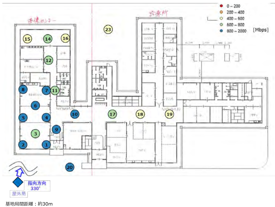
図 5.3.5-8 (b) 屋内の測定結果 (再掲) 診療所屋外局周辺での伝送スループット (DL) 測定結果
