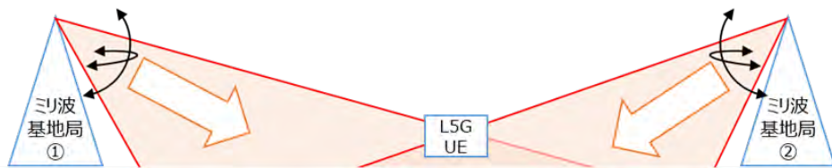
図 5-2-2-3 ミリ波基地局①②間の電波干渉の模式図
