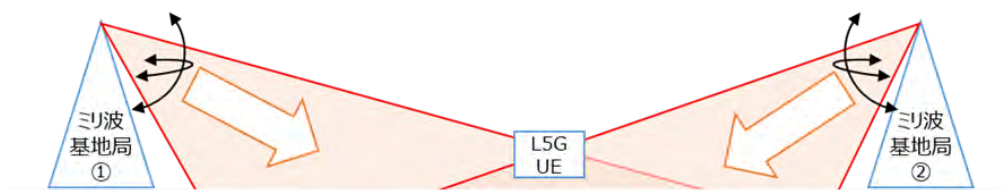
図 5-4-1-1 ミリ波基地局①②間の電波干渉の模式図
