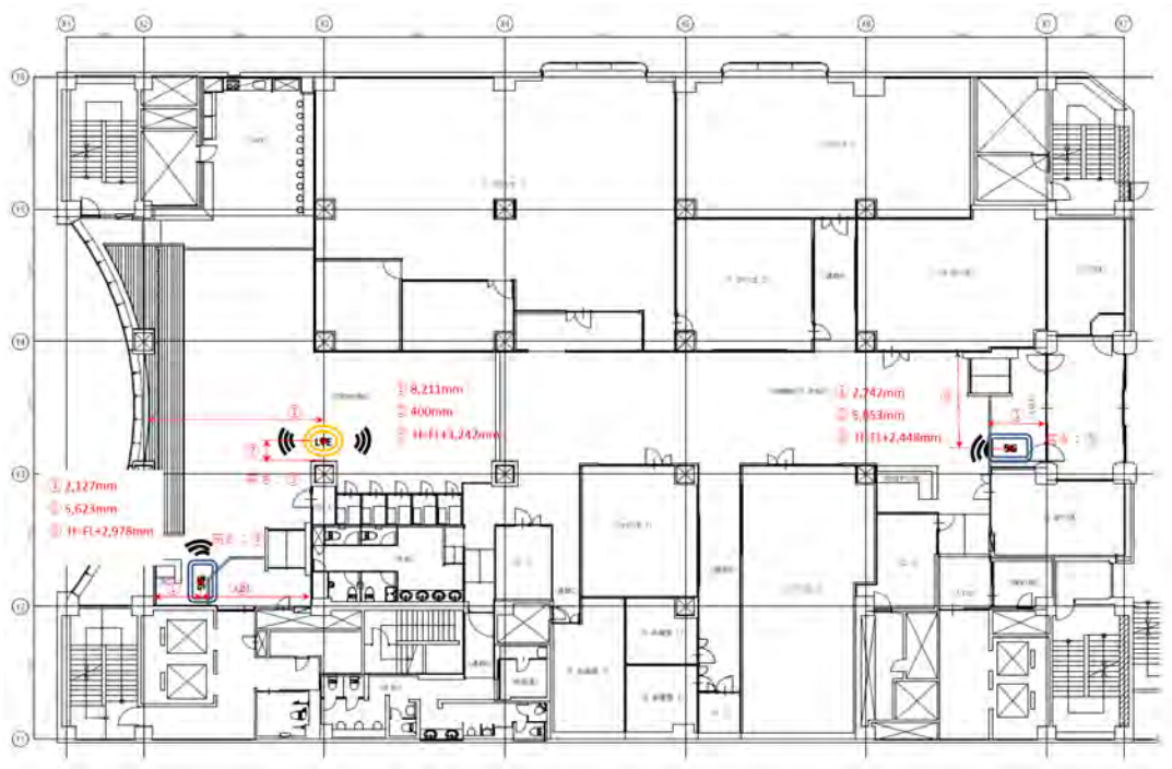
図 3-1-3 機器配置図 (ローカル 5 G)
