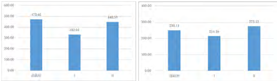
図 5-3-4-28 ポイント 8_各遮蔽パターンにおけるスループット (左上：UL/PUSCH、 右上：UL/ MAC、左下：DL/PDSCH、右下：DL/MAC) (単位：Mbps)
