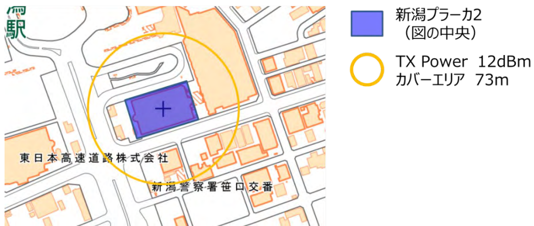
図 1-5-6 電波法関係審査基準伝搬式によるカバーエリア (2.5GHz) (国土地理院 (URL : https://www.gsi.go.jp ) のデータを使用して作成)
