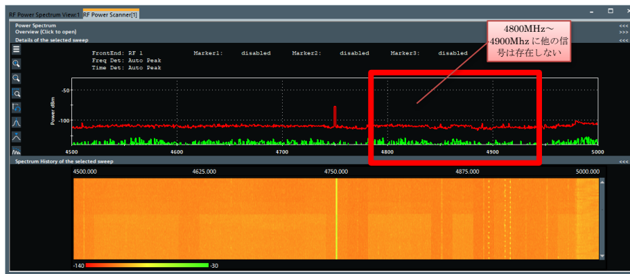
図 5.4.1.3-2 電波発射前の周辺周波数帯の状況
