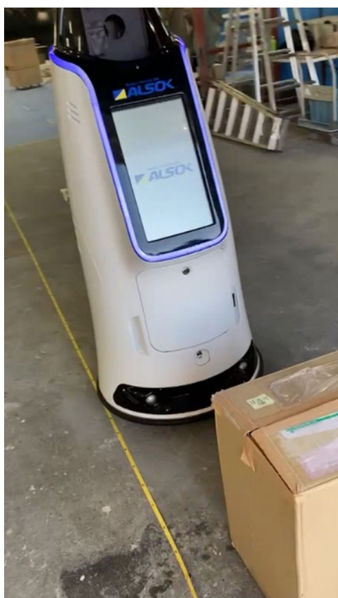
図 4.3.3.5-3 障害物（段ボール）検知の様子
