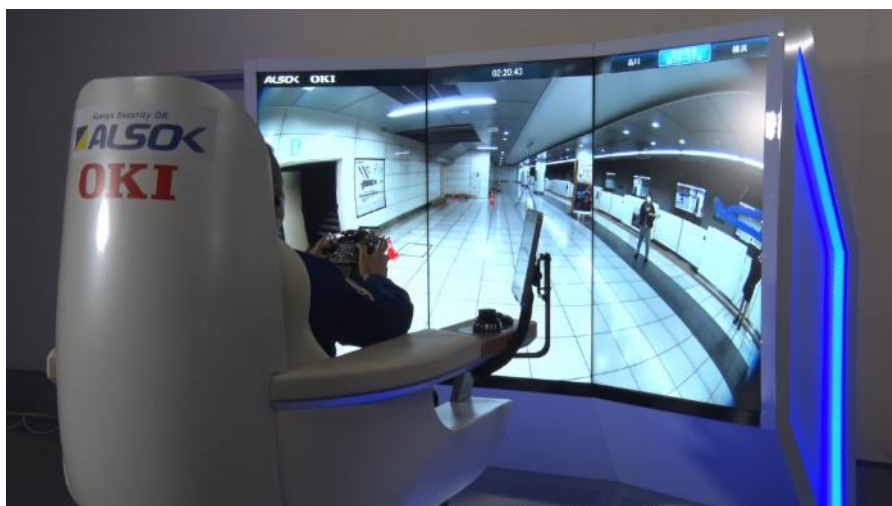
図 4.3.2.5-13 CPT より遠隔操縦する様子
