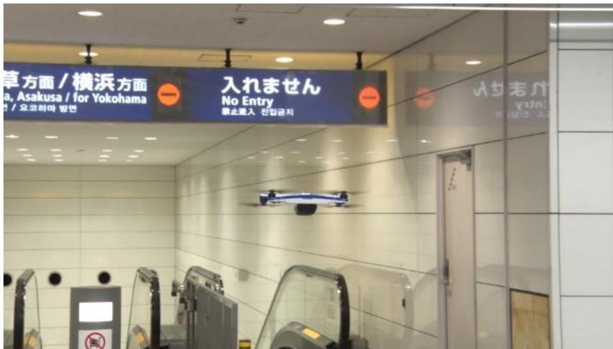
図 4.3.2.5-2 自動巡回中のドローン①
