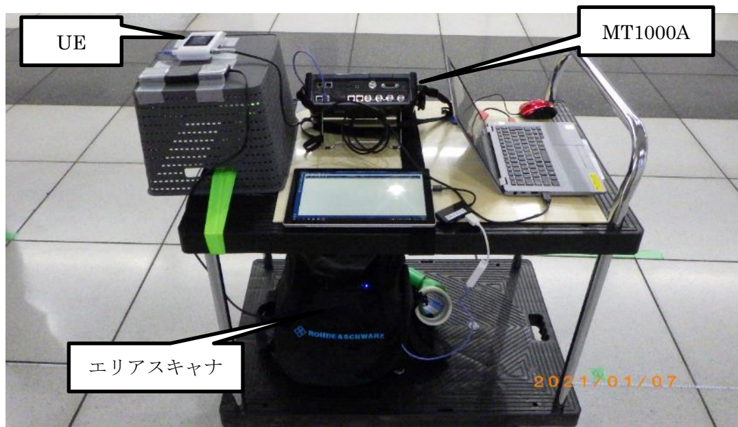
図 5.1.3.3-5 B2F 設置機器 (エリアスキャナ・UE・MT1000A) の設置風景 注)UE… 5 G 陸上移動局
