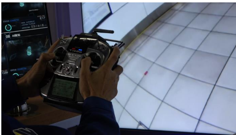
図 4.3.2.5-17 制御伝送遅延計測中の様子
