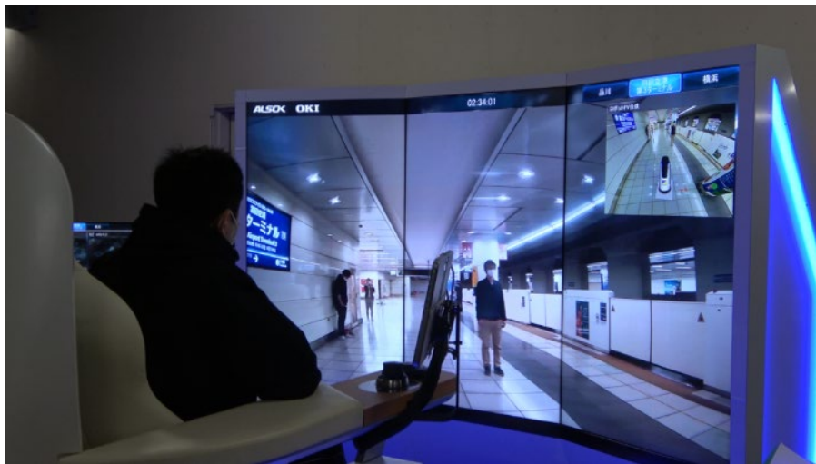
図 4.3.3.5-2 自動巡回中のロボットから配信された遠隔監視映像
