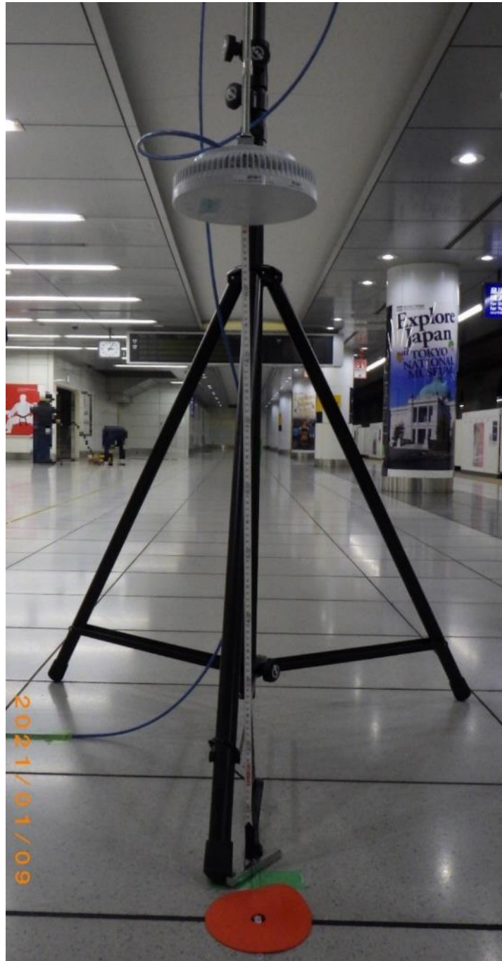
図 5.1.3.2-4 アンテナの設置風景 (アンテナ高 1m)
