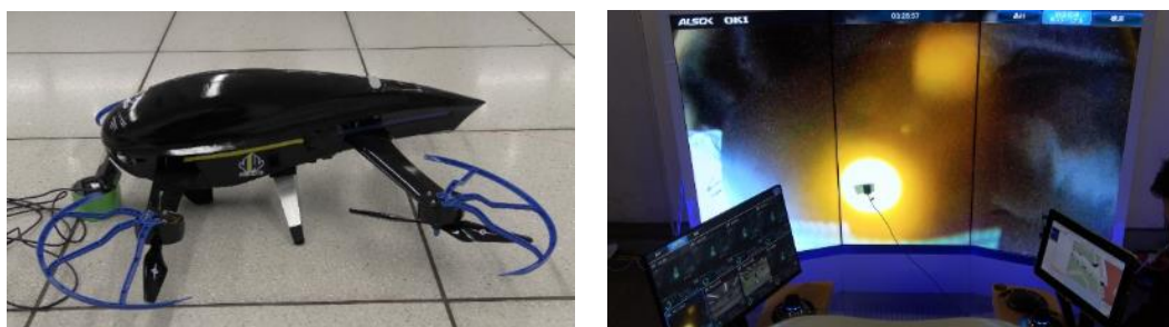
図 4.3.2.5-16 映像遅延ユニットで遅延計測している様子 (左:カメラ前に設置した発光部、右:CPTに設置した受光部)
