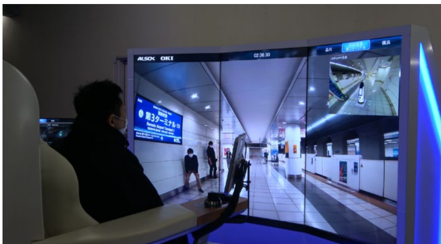
図 4.3.3.5-9 コマ落ち確認に使用した映像例（被写体が大きく動くものを採用）
