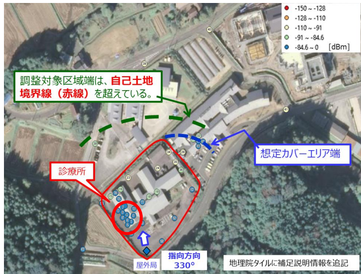
下り受信電力(SS-RSRP)から評価した想定エリア(診療所屋外含む)
