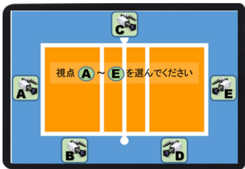
図 4.3-8 視聴用端末の5つの視点の位置図 (A・E：サブ後方視点、B・D：ベンチ視点、C：主審視点)
