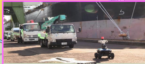
自動走行ロボットによる車両誘導
