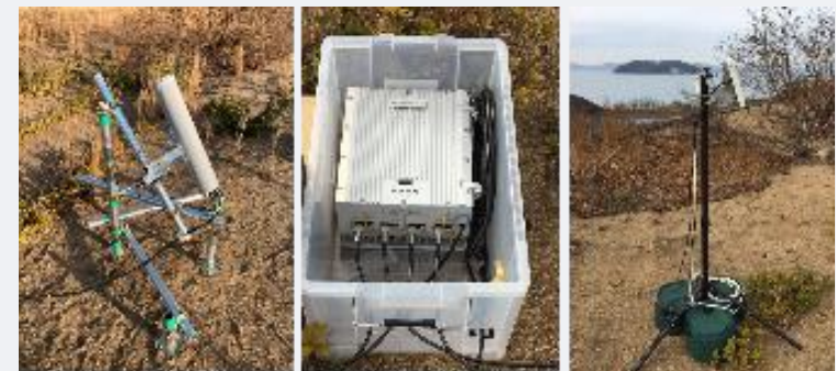
レピータ (サービスアンテナ・レピータ・ドナーアンテナ)
