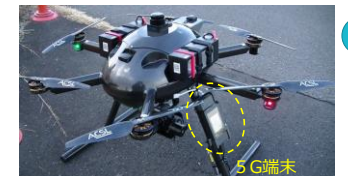
国産ドローン(5G端末搭載) 端末: K5G-C-100A
