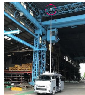
ハイエースに伸縮ポール(最大10m)と頂部に5G機器を搭載
