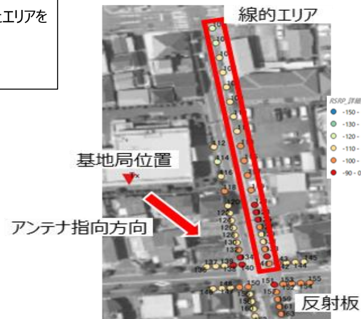
図3 反射板の設置位置と電界測定結果
