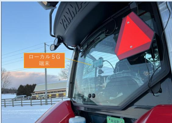
農機(ロボットトラクタ)内のリアガラス前にローカル5G端末を設置。複数のDASアンテナの位置関係及びロボットトラクタのボディの位置関係で、映像に乱れが発生しスループットも数値的に低くなる傾向にあることがわかった。
