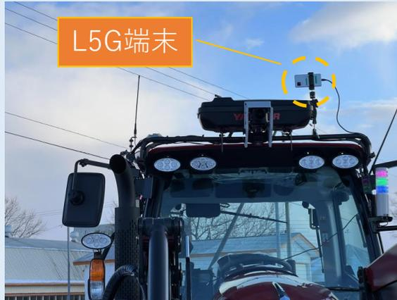
ローカル5G端末を天井位置に取付け。設置を実用可能とするには、ローカル5G端末が剥き出しにならないよう、雨雪対策用にBOXに入れる等の対応が必要となる。
