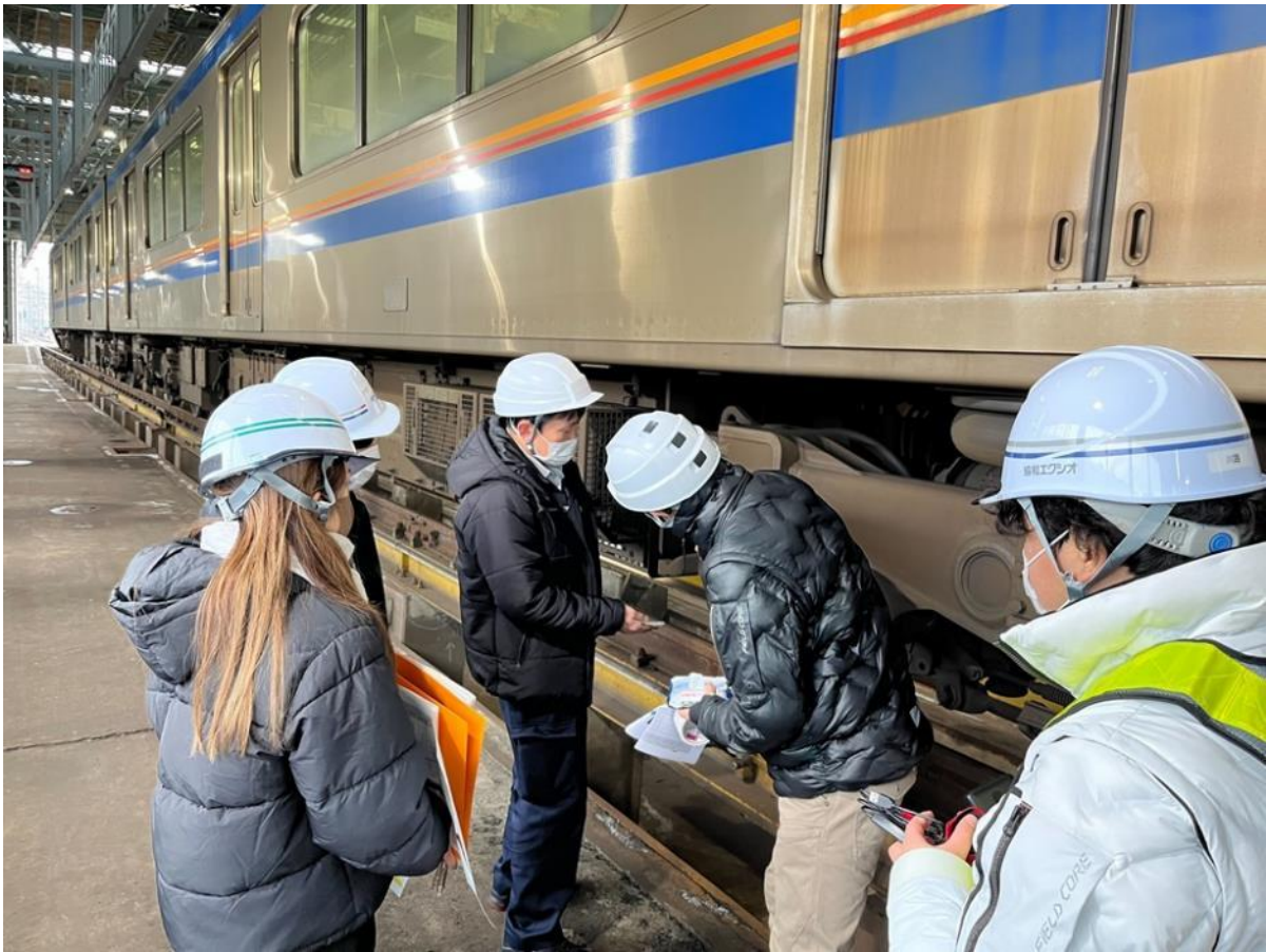
図 3.2.2-12 筑紫車両基地内検査庫の車両への疑似き裂（クラックシール）貼付作業状況
