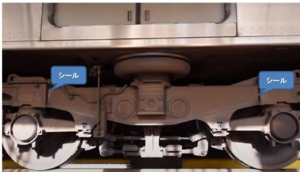
図 3. 3. 1-6 台車のき裂検出における擬似き裂シール添付場所
