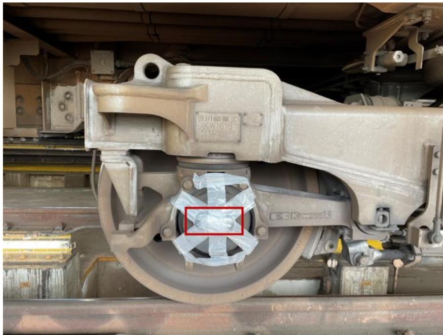
図 3. 2. 2-18 車軸の温度異常検出用サーマルカイロ設置箇所
