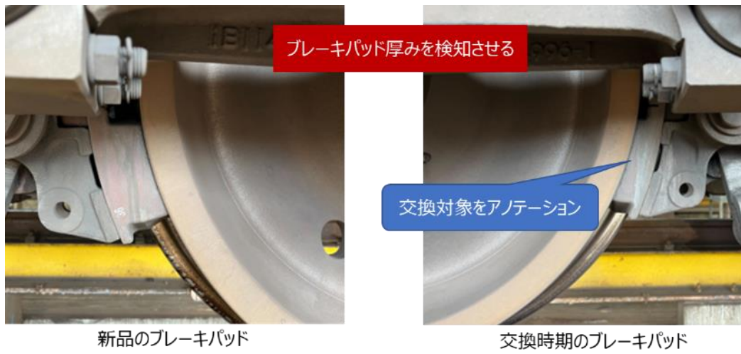
図 3. 3. 1-8 ブレーキパッドすり減り検知
