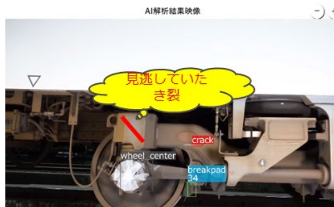
図 2.3.3-4 令和 4 年度 5G ソリューション共用実証において構築した SaaS 型「鉄道車両監視 AI システム」のアノテーション支援ツール利用による検出動作の改善イメージ
