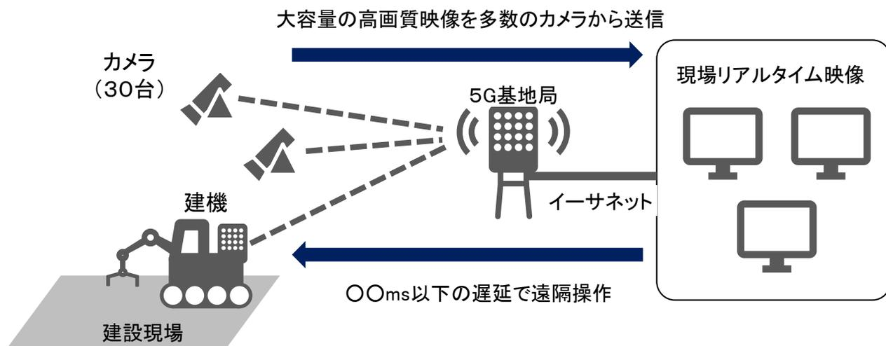
遠隔で現場監視、機器の操作を行うことにより、作業の効率化、安全性の向上を実現
