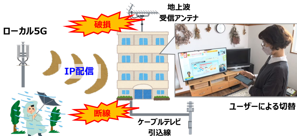
台風等によるテレビ放送受信障害の ローカル5Gを活用したIP配信への切替
