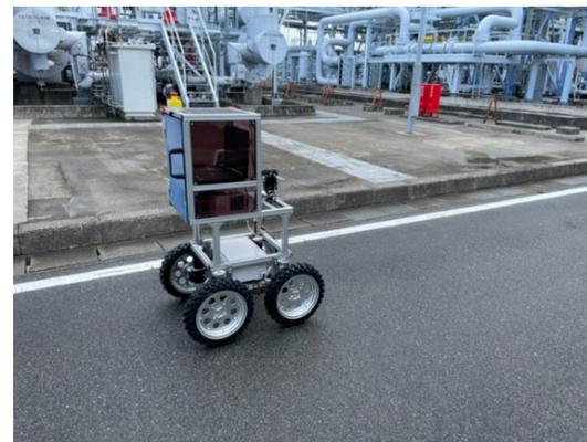
写真＊ ロボット自動ガス測定状況
