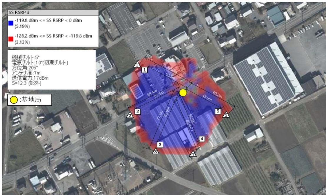
図 3-5 いちご畑花園 エリア算出法により算出されたカバーエリアおよび調整対象区域と測定ポイント（ハウス B）
