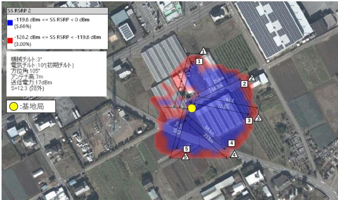
図 3-4 いちご畑花園 エリア算出法により算出されたカバーエリアおよび調整対象区域と測定ポイント（ハウス A）
