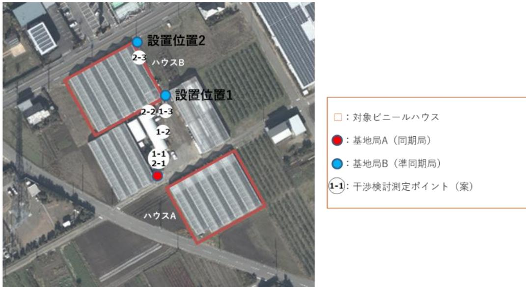
図 3-117 干渉検討測定ポイント (再掲)
