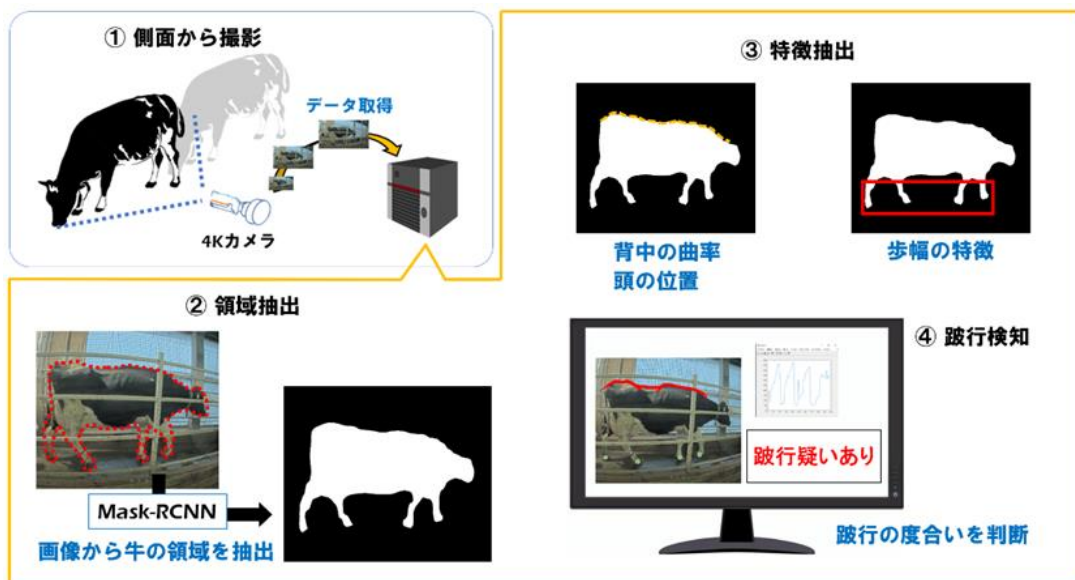
図 4.4.1.1-7 4K カメラによる跛行検知システムの流れ
