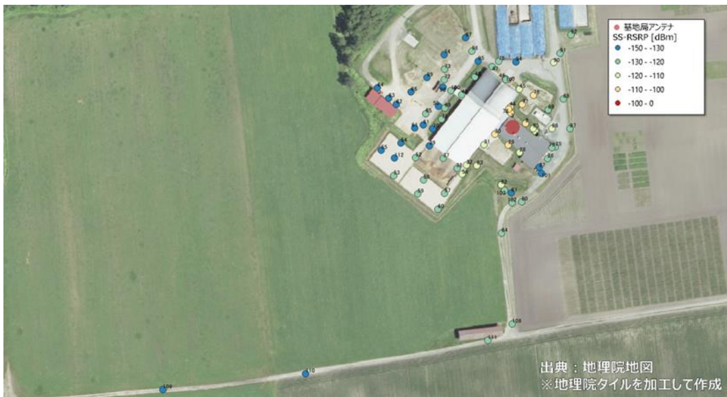
図 3.3.1.4-3(b) 牛待機室側基地局を対象とした SS-RSRP 測定結果（屋外測定点）
