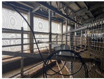
図 4.4.1.1-1 跛行検知システムにおける各カメラの設置箇所 (図の左下が 4K カメラ、右下が 3D カメラの現地での設置状況)
