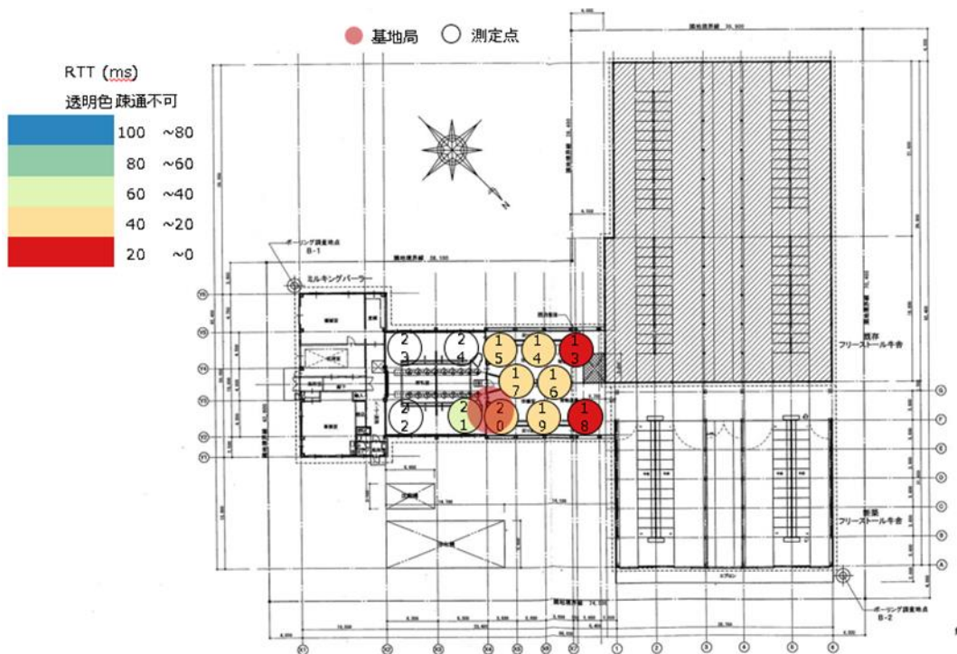
図 3.3.1.4-8(c) 牛待機室側同期基地局(TDD)を対象とした RTT 測定結果
