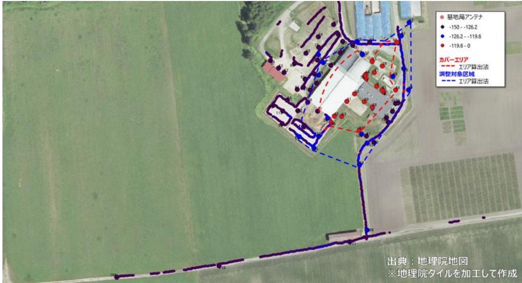
図 3.3.2.5-2(b) 実測値から推定した カバーエリアおよび調整対象区域：牛待機室側基地局
