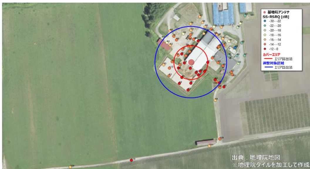
図 3.3.1.4-14(b) 牛舎側基地局における受信レベル SS-RSRQ から評価した 想定カバーエリア（屋外測定点）
