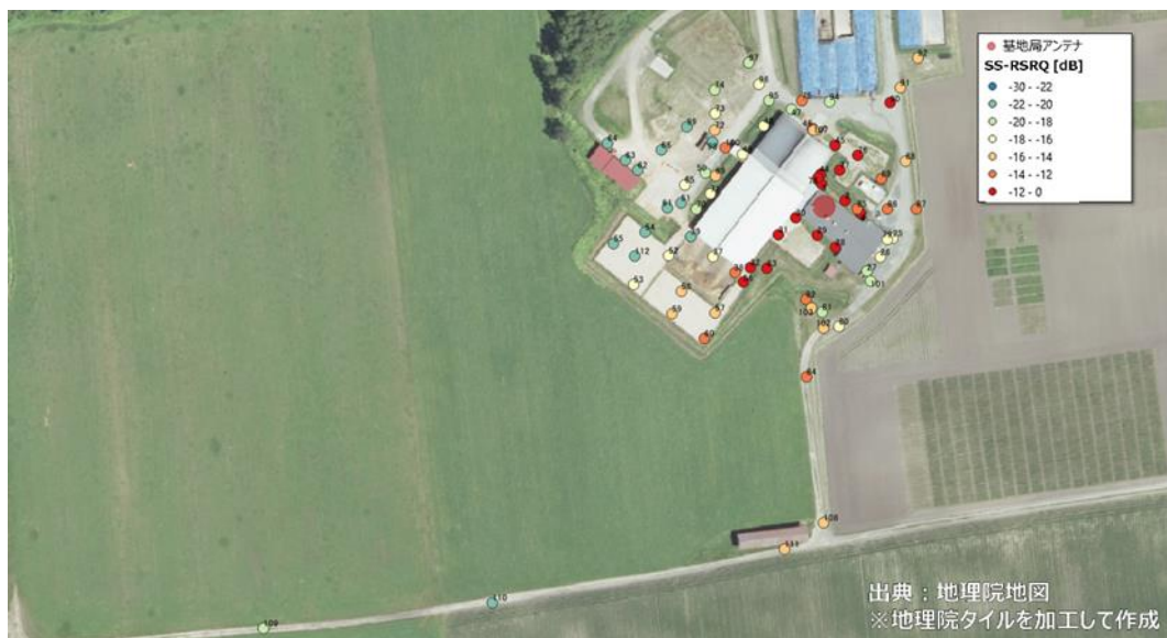
図 3.3.1.4-4(b) 牛待機室側基地局を対象とした SS-RSRQ 測定結果 (屋外測定点)
