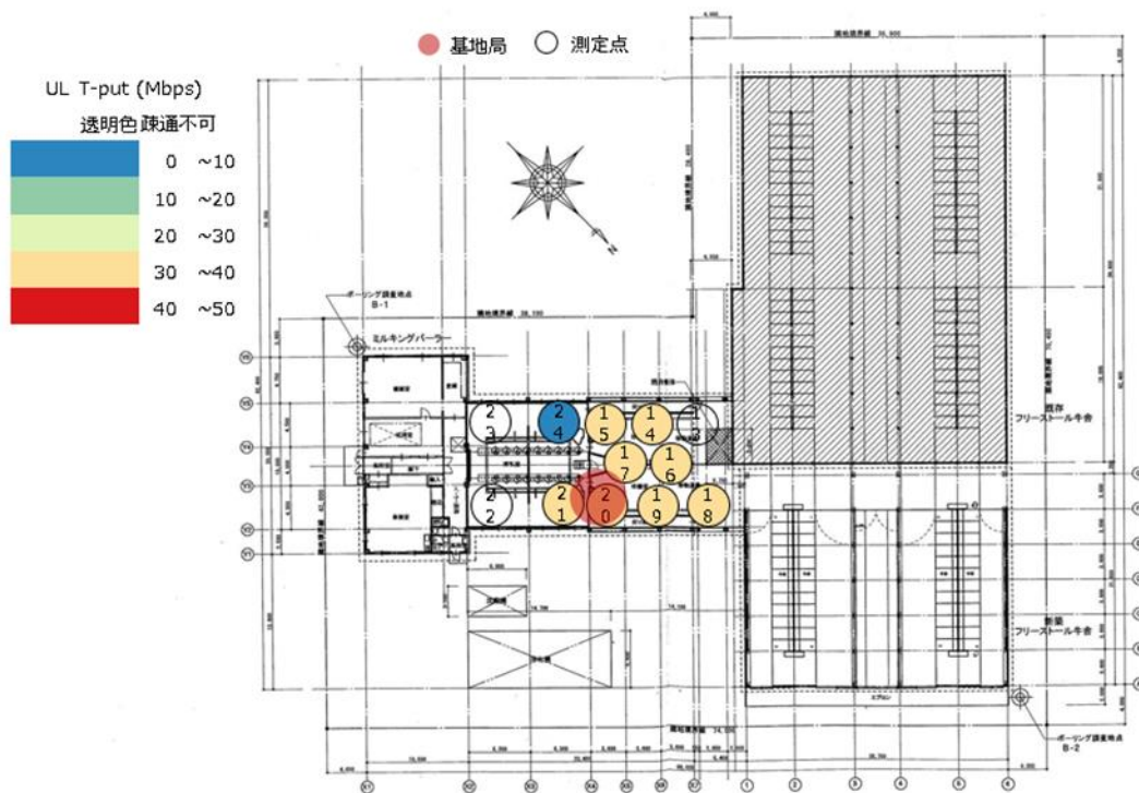
図 3.3.1.4-10(a) 牛待機室側制度化済準同期基地局(TDD1)を対象とした 伝送スループット (UL) 測定結果
