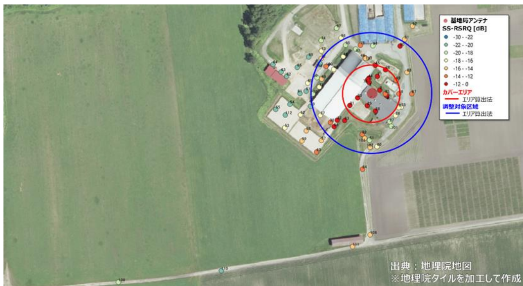
図 3.3.1.4-16(b) 牛待機室側基地局における受信レベル SS-RSRQ から評価した 想定カバーエリア (屋外測定点)
