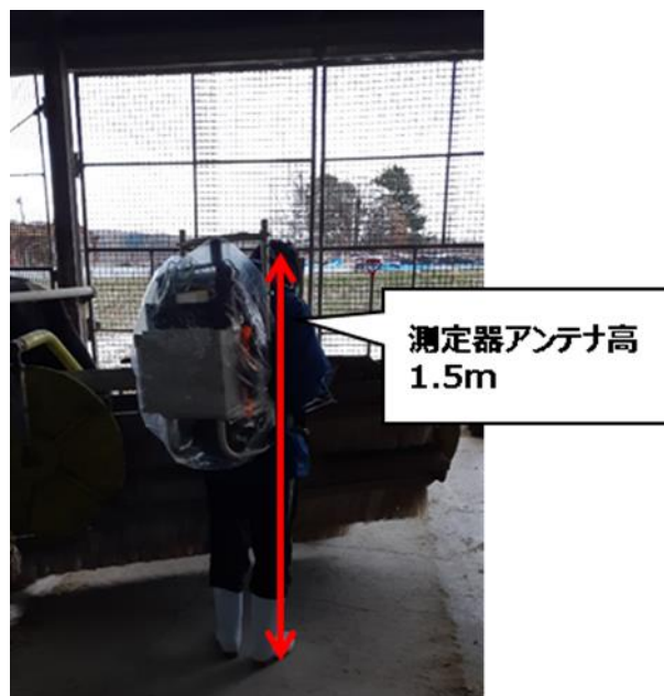
図 3.2-6 実測に用いる測定補助用治具
