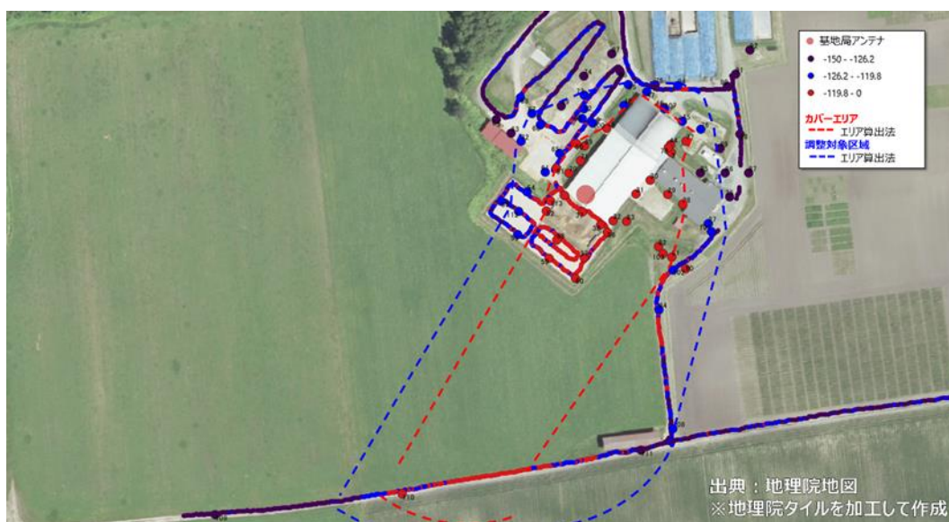
図 3.3.2.5-2(a) 実測値から推定したカバーエリアおよび調整対象区域：牛舎側基地局
