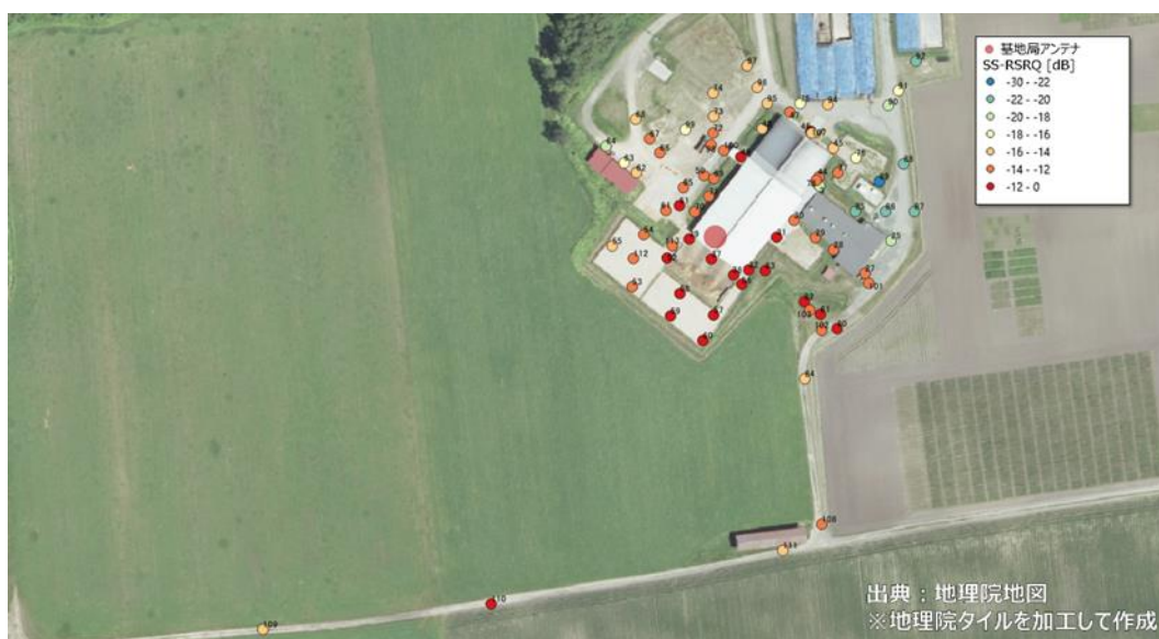
図 3.3.1.4-2(b) 牛舎側基地局を対象とした SS-RSRQ 測定結果 (屋外測定点)
