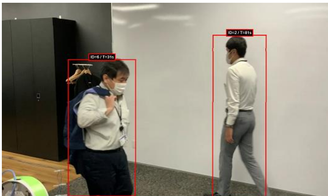
図 4-9 AI 解析サーバでの映像解析（人物検出のイメージ）
