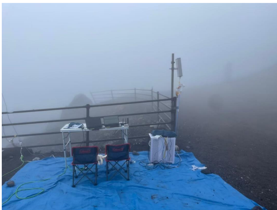
図 2-14 6合目安全指導センター前に設置した一体型基地局 (FLARE 基地局/アンテナ)
