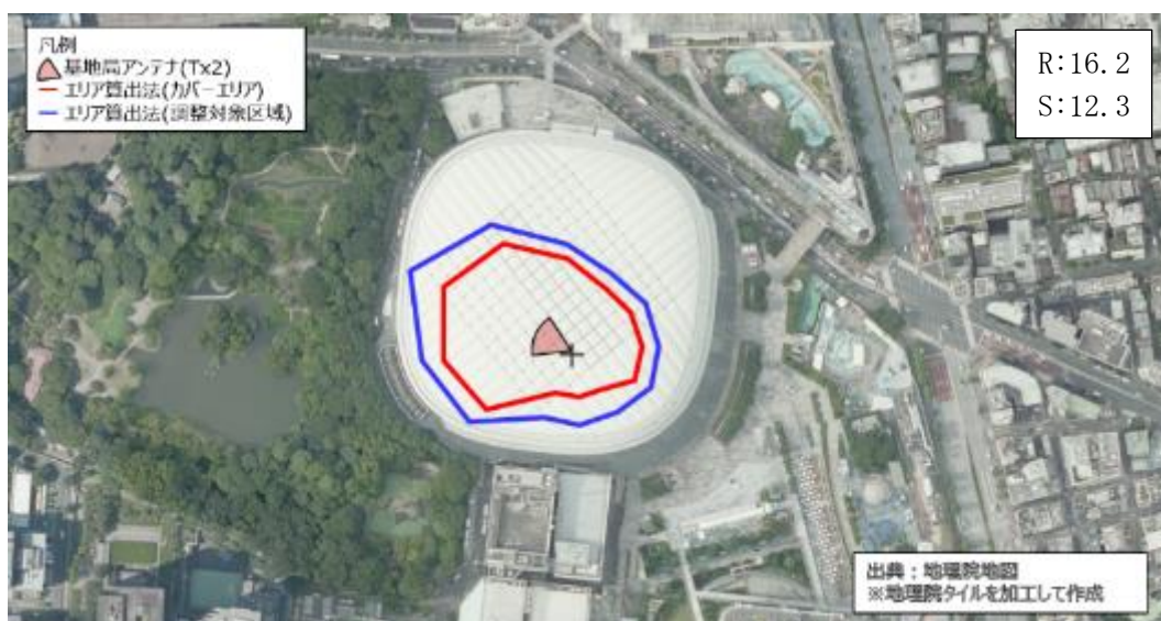
図 3.3.1.3-1(b) エリア算出法に基づくカバーエリア及び調整対象区域図 (三塁側基地局：Tx2)
