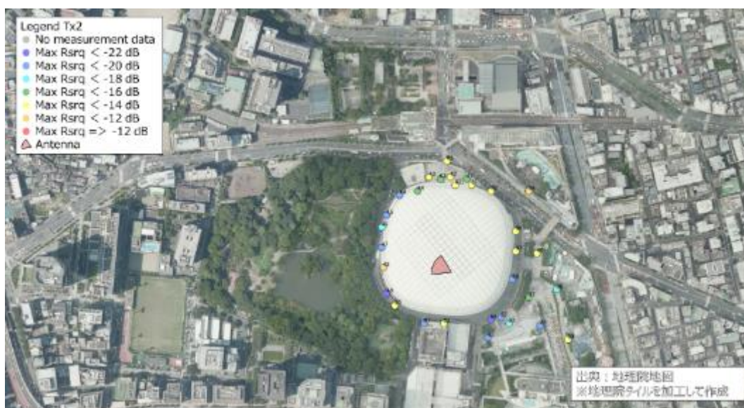
図 3.3.1.4-5(c) 三塁側基地局 (Tx2) SS-RSRQ 測定結果：屋外環境 (再掲)
