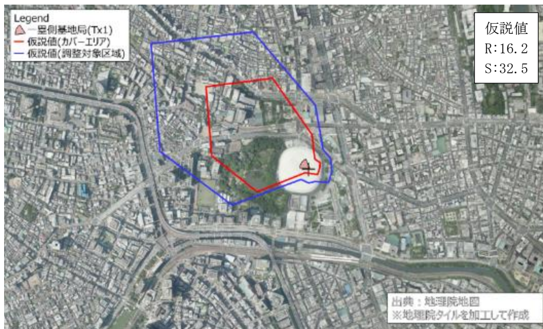
図 3.3.2.2-1(a) 仮説パラメータ R (=16.2dB) S (=32.5) を用いて算出した カバーエリアおよび調整対象区域：一塁側基地局 (Tx1)
