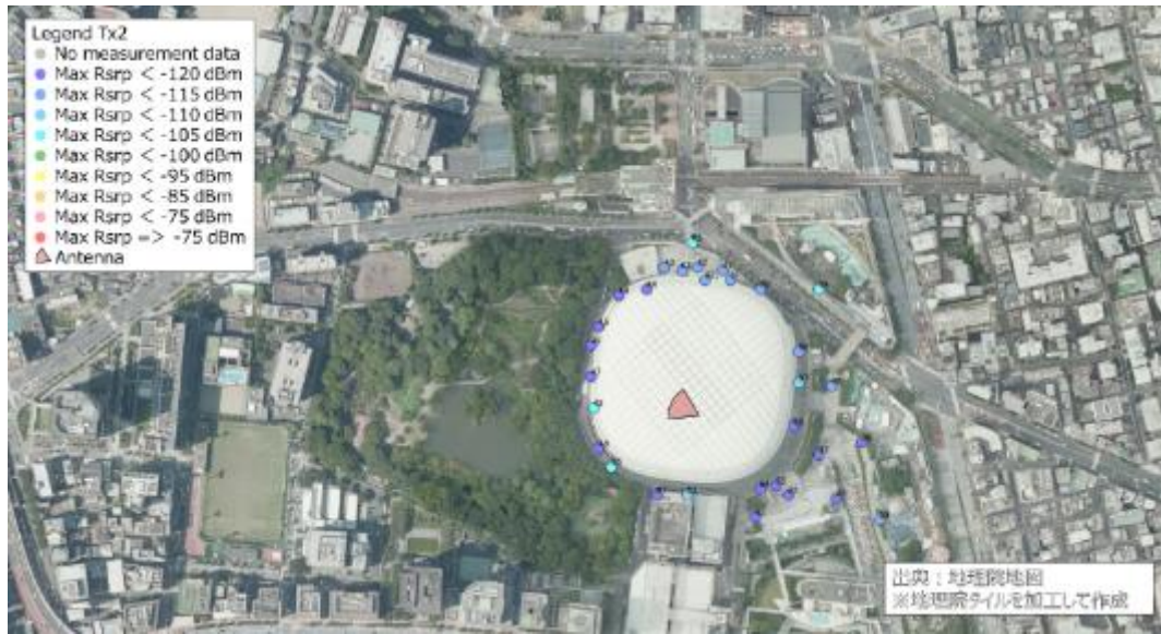
図 3.3.1.4-4(c) 三塁側基地局 (Tx2) SS-RSRP 測定結果：屋外環境
