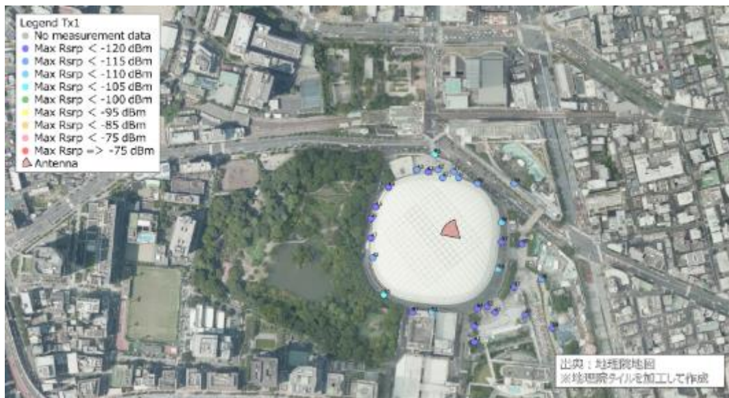
図 3.3.1.4-1(c) 一壘側基地局 (Tx1) SS-RSRP 測定結果：屋外
