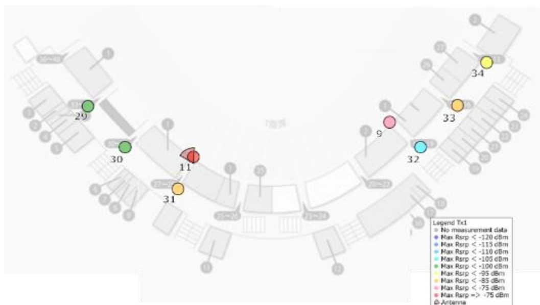
図 3.3.1.4-4(b) 三塁側基地局 (Tx2) SS-RSRP 測定結果：屋内グルメロード
