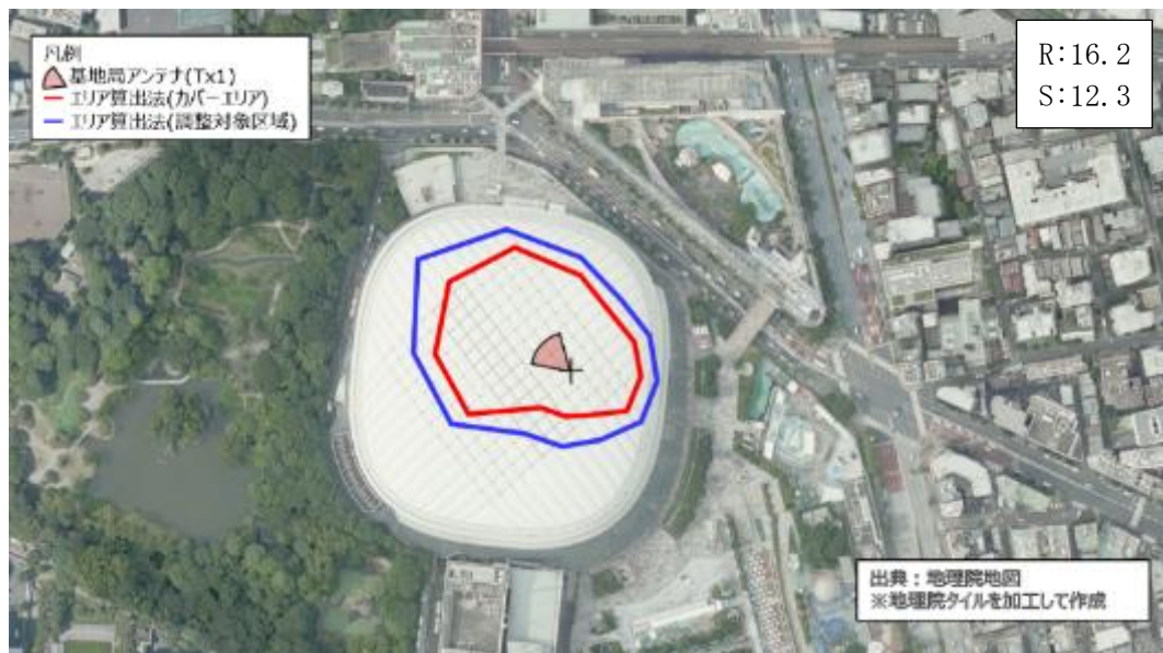
図 3.3.1.3-1(a) エリア算出法に基づくカバーエリア及び調整対象区域図 (一塁側基地局：Tx1)
