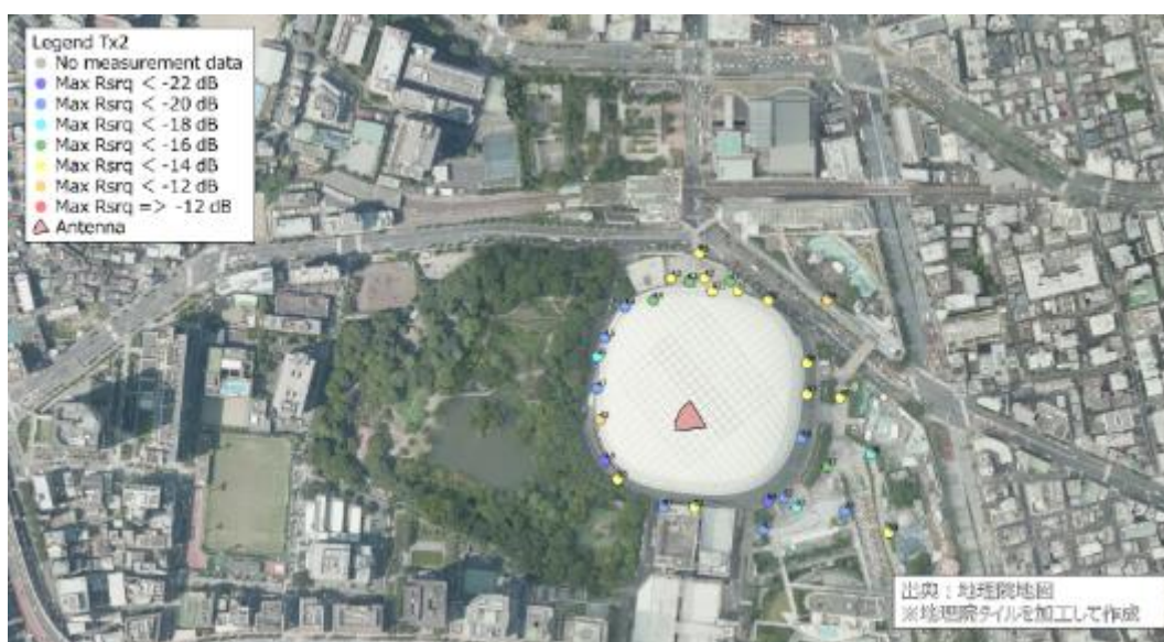
図 3.3.1.4-5(c) 三塁側基地局 (Tx2) SS-RSRQ 測定結果：屋外環境
