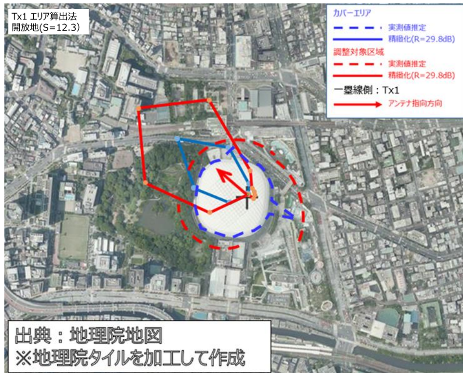
図 3.3.2.5-7(a) 精緻化エリア図と実測値推定エリア図との比較：一塁線側 Tx1
