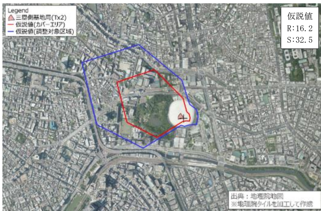
図 3.3.2.2-1(b) 仮説パラメータ R (=16.2dB) S (=32.5) を用いて算出した カバーエリアおよび調整対象区域：三塁側基地局 (Tx2)
