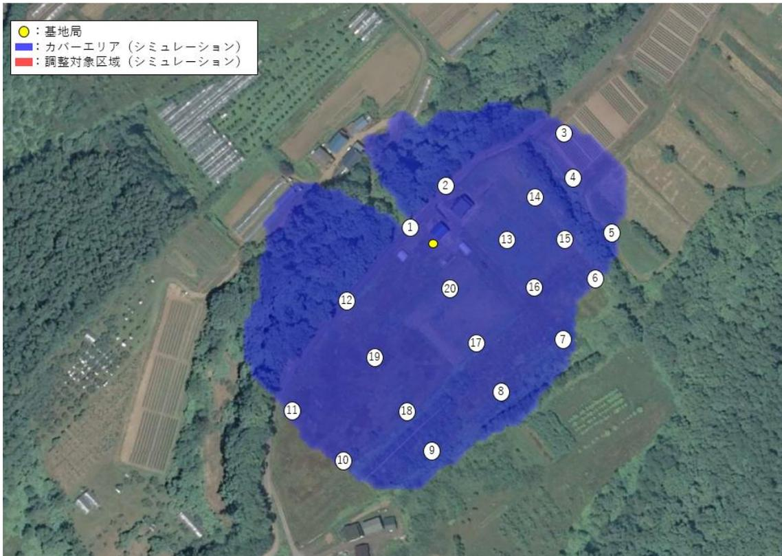
図 3.3.25 基地局 C カバーエリアと伝送性能の測定ポイント
