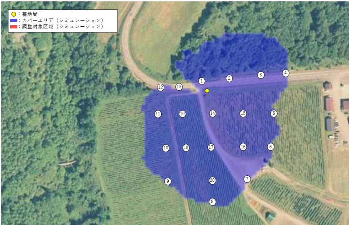
図 3.3.23 基地局 A カバーエリアと伝送性能の測定ポイント
