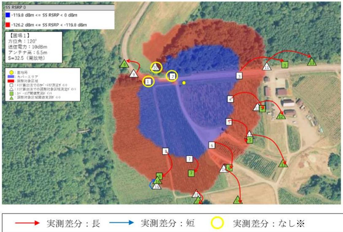
図 3.3.14 基地局 A エリア算出法と実測値の比較
