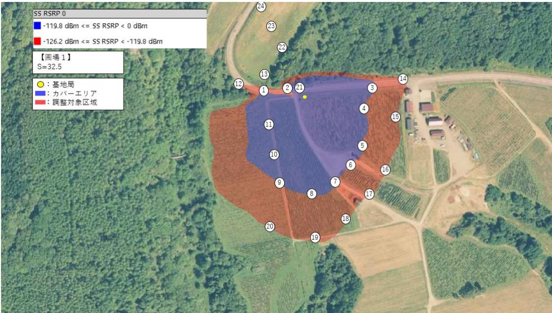
図 3.3.27 ローカル 5G 基地局 A 仮説パラメーターで算出したカバーエリア、調整対象区域及び測定ポイント
