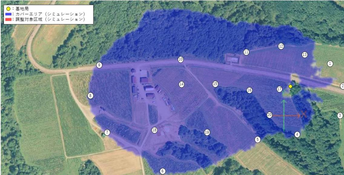
図 3.3.6 ローカル 5G 基地局 B カバーエリア内外測定ポイント
