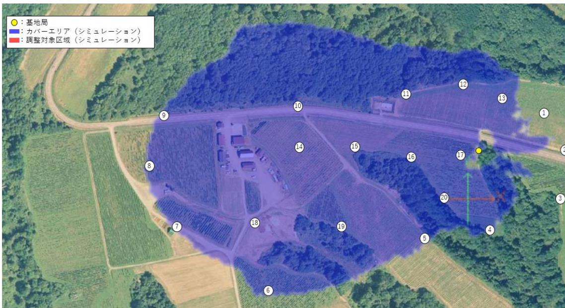
図 3.3.24 基地局 B カバーエリアと伝送性能の測定ポイント
