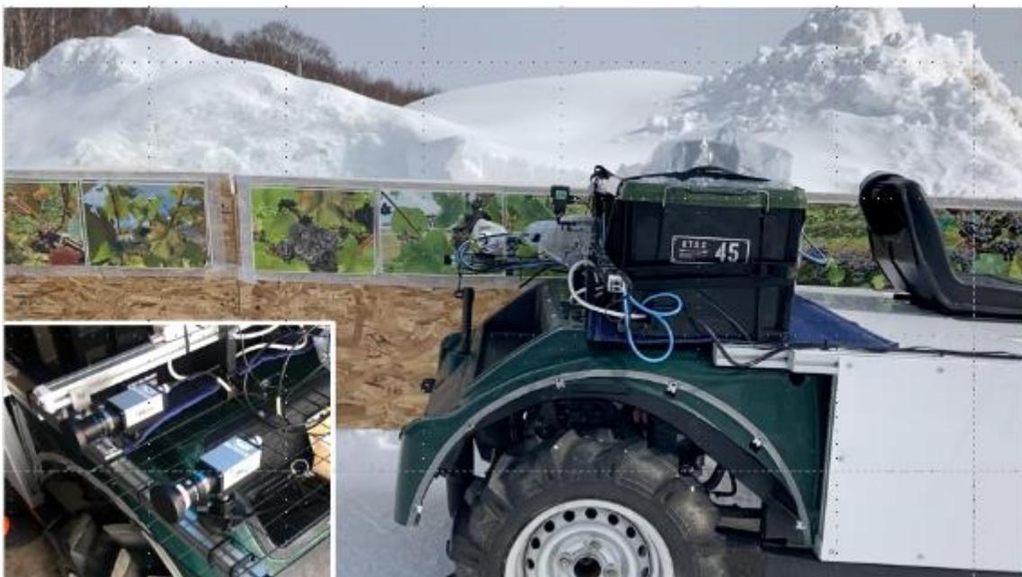
図 4.4.25 EV 走行による病虫害検出（実証の様様）
