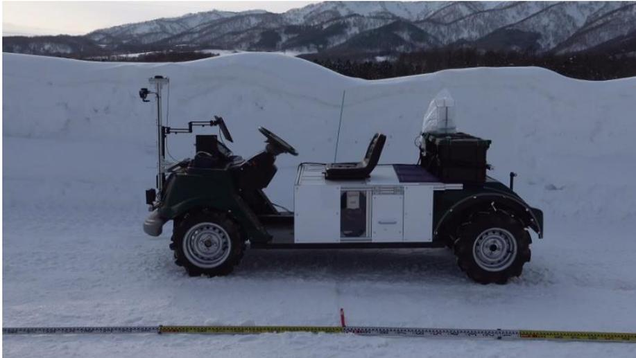
図 4.4.10 緊急停止距離測定実施模様
