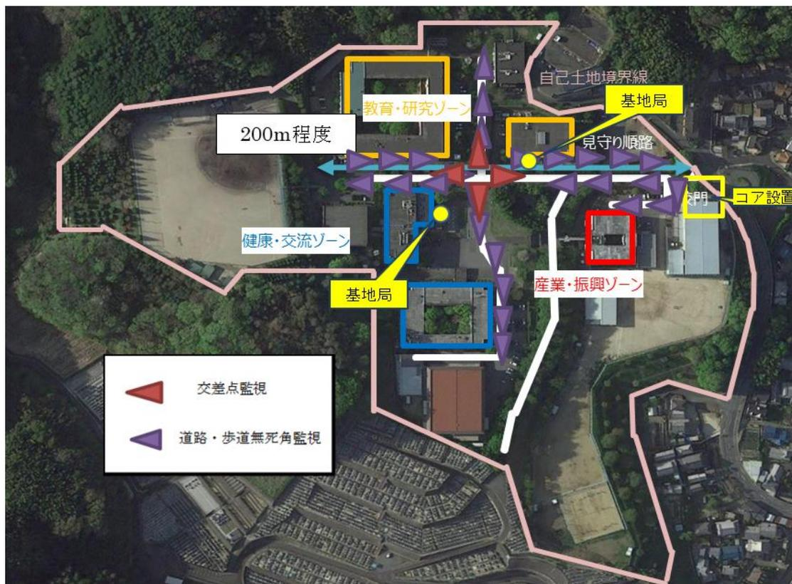
図 4.4.15 固定式監視カメラ設置イメージ
