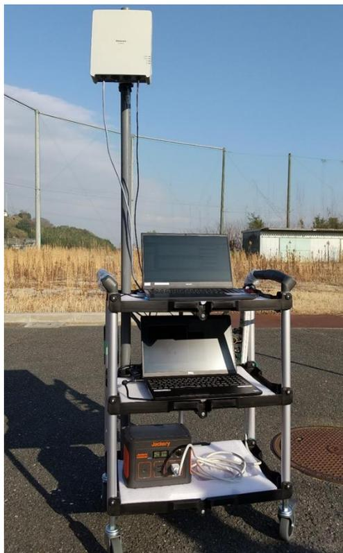
図 3.3.12 スループット測定に使用した UE 及び測定用 PC
