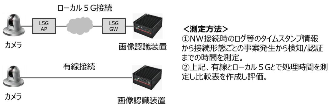
図 4.4.17 検知時間測定の検証イメージ
