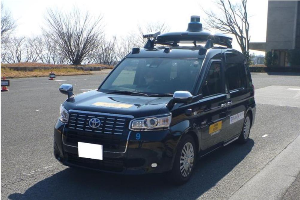
図 4.3.12 自動運転検証車両 (JAPAN タクシー)
