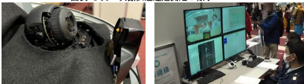
図表 4-90 映像伝送遅延測定の様子
