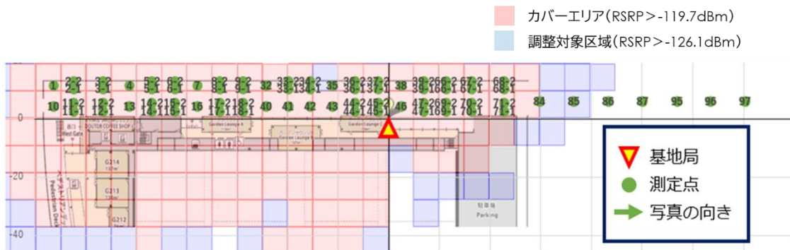
図表 3-97 2F ガーデンラウンジ ガラス壁を挟む屋外環境 測定点
