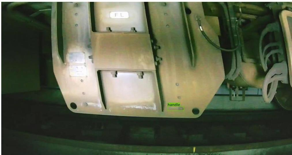
図 4.4.1.1-77 京浜急行電鉄 8 両編成車両ハンドルの誤検出の例②（ハンドルの形状に似た汚れ）
