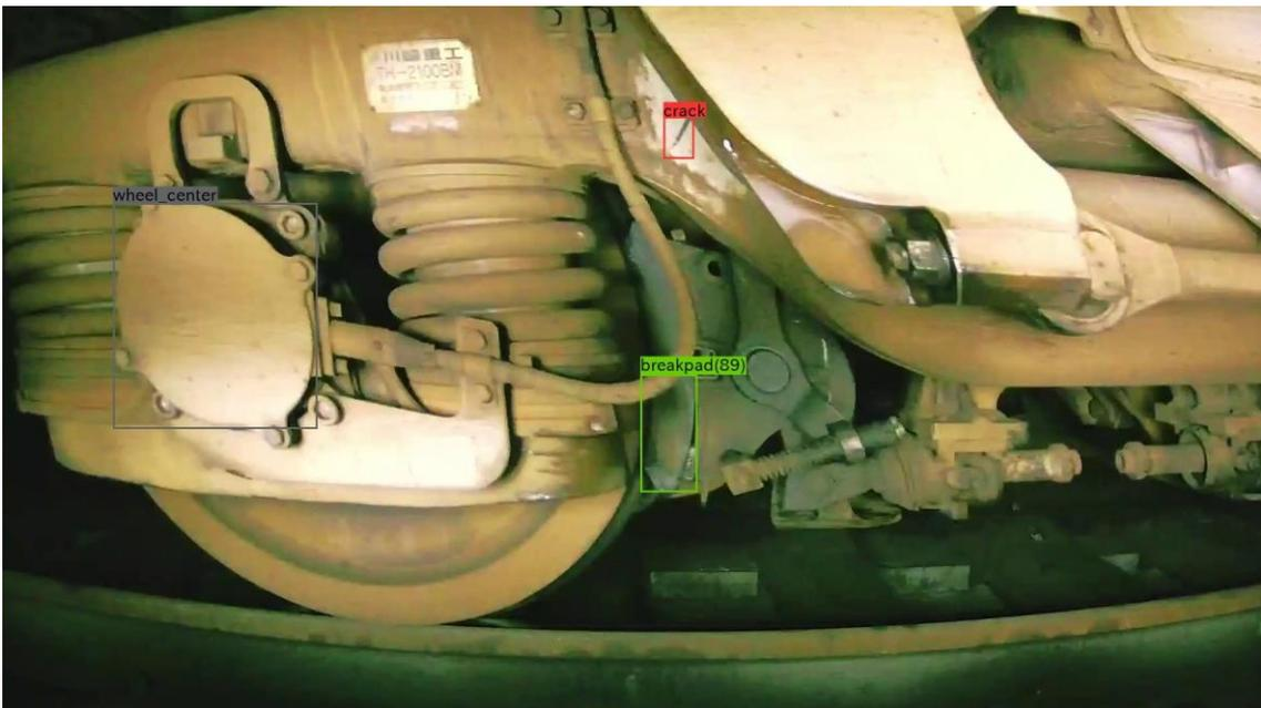
図 4.4.1.1-70 チューブのようなものが重なるブレーキパッドの例②（追加学習後）
