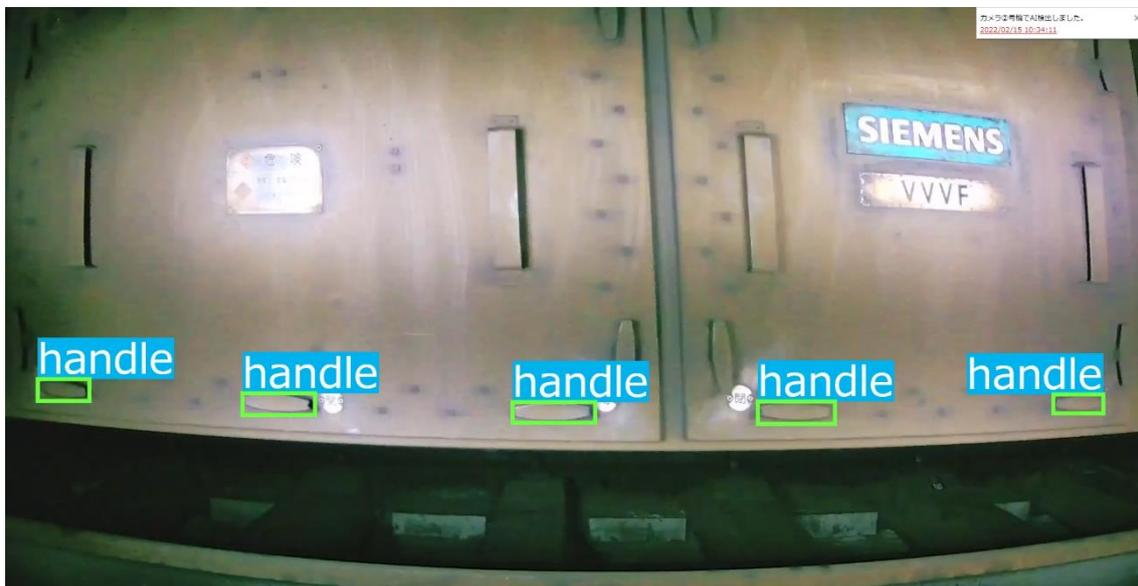
図 4.4.1.1-75 京浜急行電鉄 8 両編成車両ハンドルの検出結果の例
