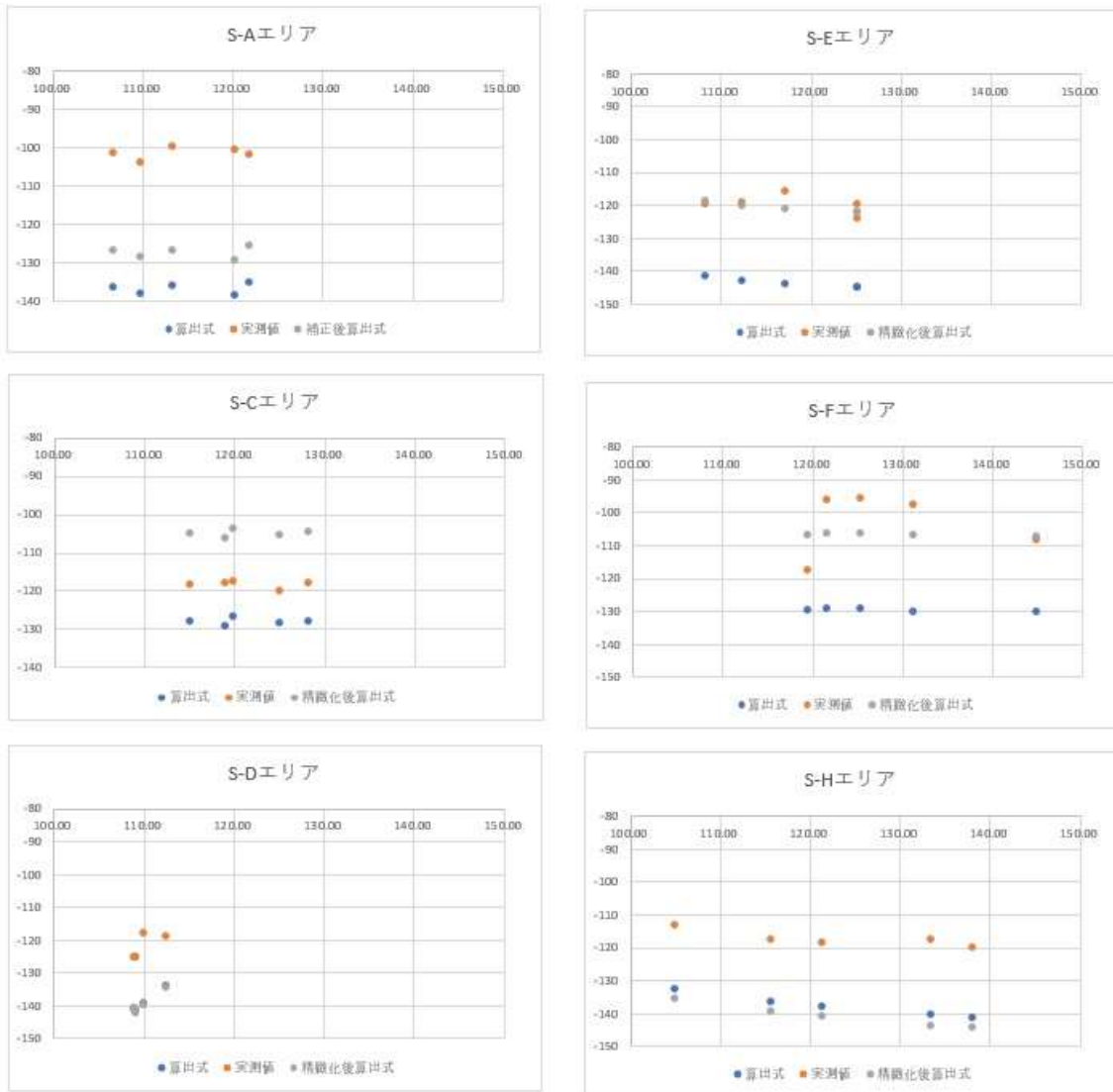
図 3.3.2.5-(3)-10 長手方向以外の S の値を使用したエリア算出式による受信電力
