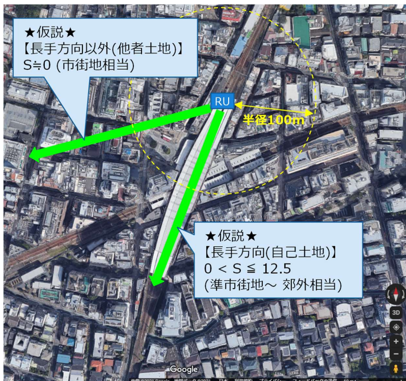
図 3.3.2.2-1) 伝搬方向によるパラメータ S の違い (東横線を例とした仮説)
