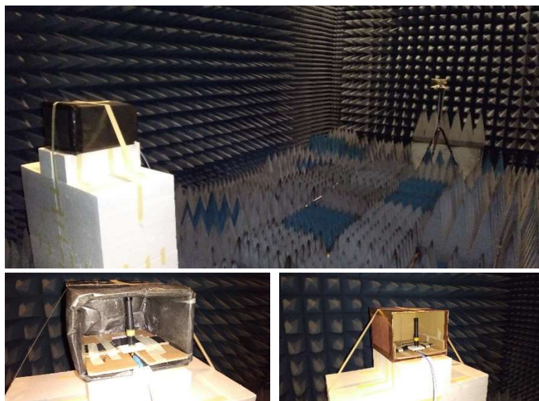
図 3.3.2.5(4)3-12 アンテナ暗室 筐体特性評価 (左下: 筐体 1、右下: 筐体 2 )
