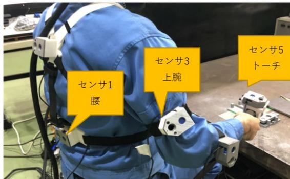
IMUセンサ(加速度センサ)を用いた動作計測
