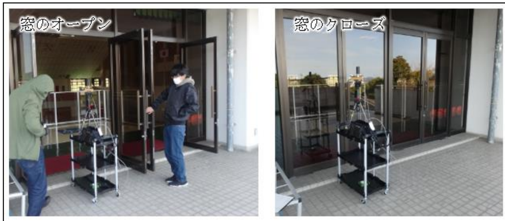
図 3.3.2.4-5) 窓の透過損測定の様子
