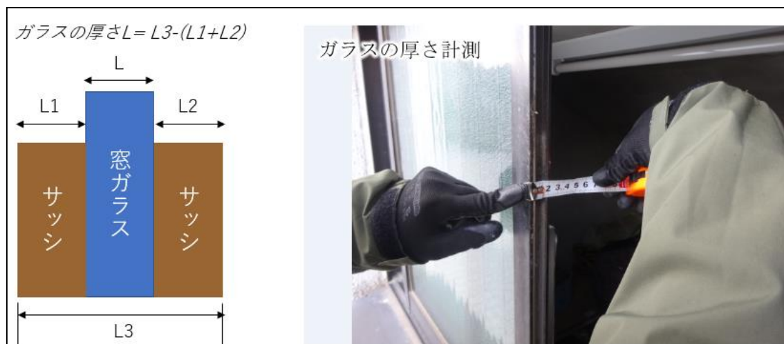
図 3.3.2.2-5) ガラスの厚さ計測
