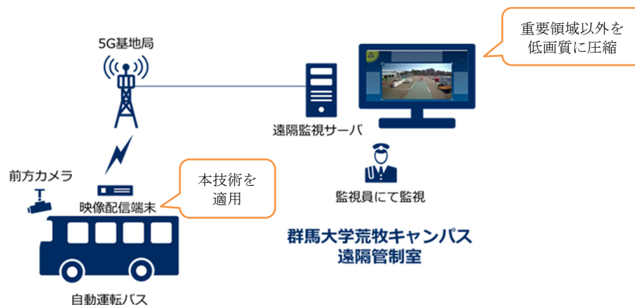
図 4-15 本技術を適用した遠隔型自動運転システム構成
