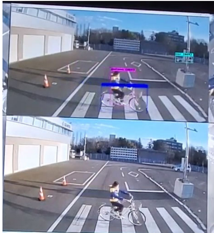
図 4-42 AIによる映像情報補助機能の機能検証の様子（遠隔管制室画面） （上：AI処理後の映像、下 AI処理前（無処理）の映像）
