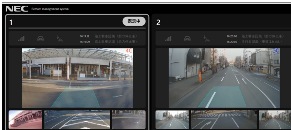
図 4-56 遠隔管制室の車両カメラ映像表示装置にて映像を表示している様子 (右側の車両②がローカル5Gに接続)
